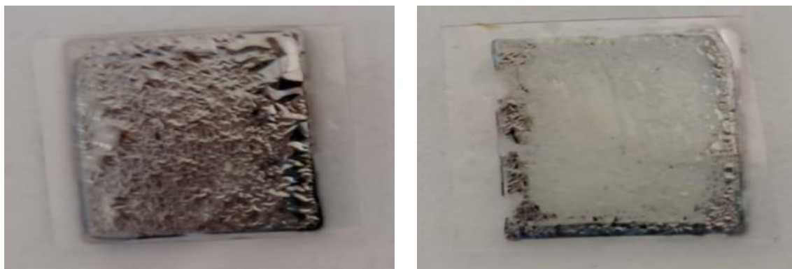
Slika 13. Usporedba Ti sloja prije elektrokemijske anodizacije uzorka na PET podlozi (slika lijevo) i uzorka TNC na PET podlozi dobivenog elektrokemijskom anodizacijom (slika desno).
