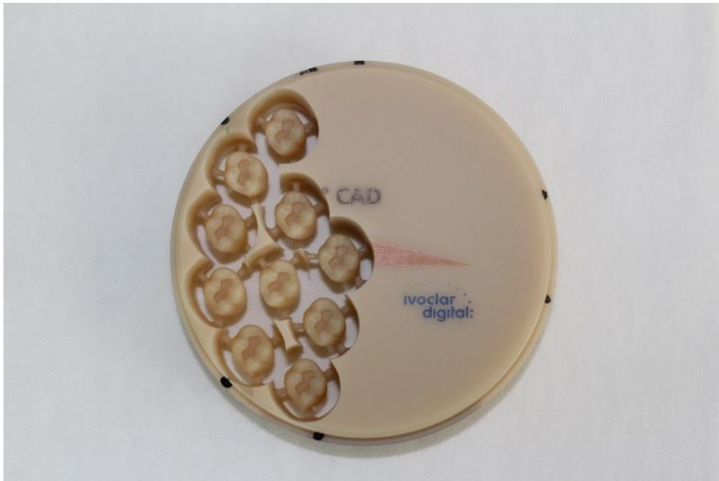
Slika 1: Iz PMMA bloka (Telio® CAD, Ivoclar Vivadent, Lihtenštajn) LT A2, izgledane su sve kopije modela zuba korištenih u istraživanju
