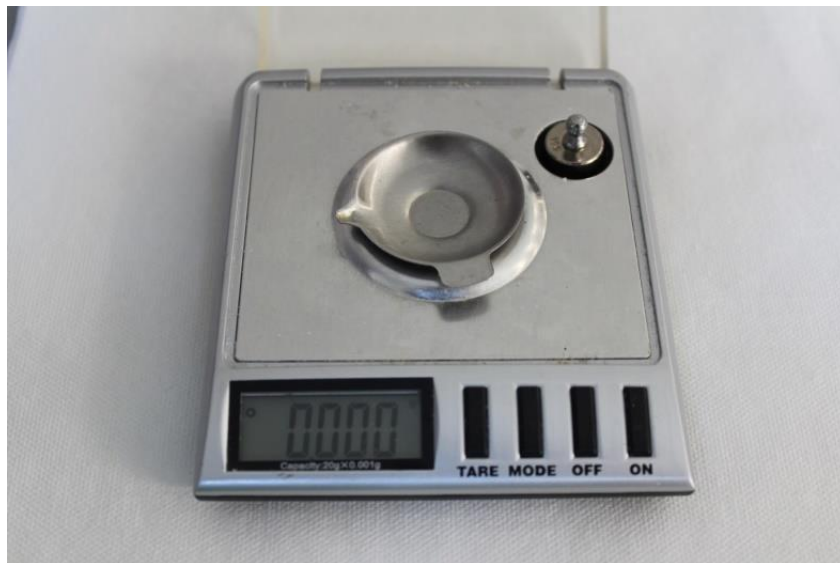
Slika 6: Potrošni materijali (dentalni kompozit i gingivna zaštita) vagani su prije i nakon izrade ispuna na digitalnoj vagi (Gemini – 20, AWS, Cumming, Georgia, SAD)
