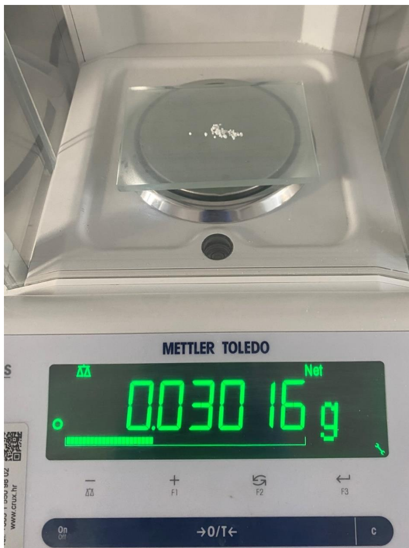
Slika 4. Mjerenje 0,03 g (10%) staklenih vlakana na preciznoj vagi
