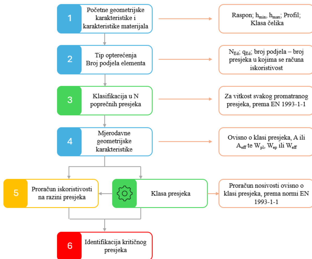
Slika 4.6 – Dijagram toka za identifikaciju kritičnog presjeka neprizmatičnog elementa
