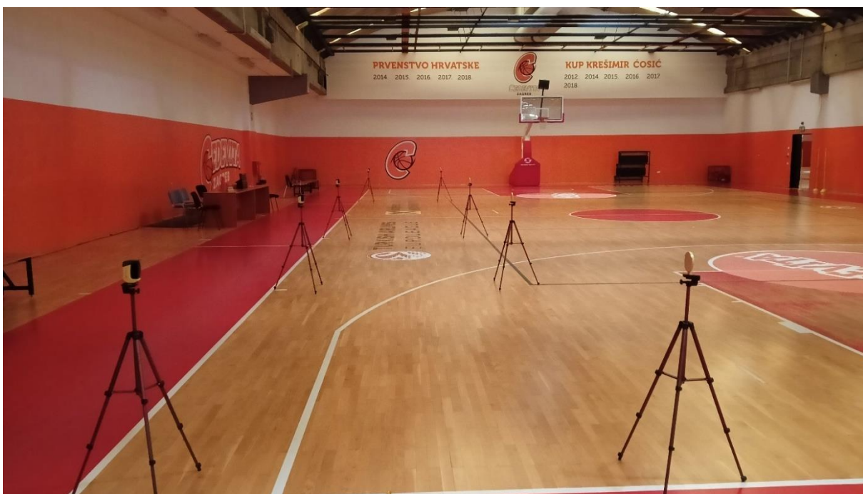
Slika 1. Prikaz Witty Gate fotočelija postavljenih na startnu liniju te na udaljenosti od 5, 10 i 20 metara
