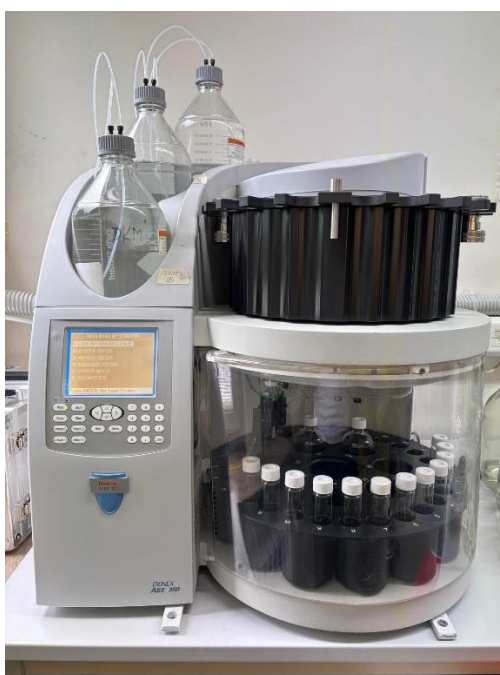
Slika 3. Uređaj za ekstrakciju krutih i polukrutih uzoraka Dionex ASE 350.
