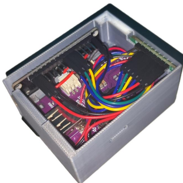
Slika 5.1 Unutarnji raspored komponenti u kućištu uređaja bez poklopca. Baterija se nalazi ispod svih komponenti i nije vidljiva na slici.
