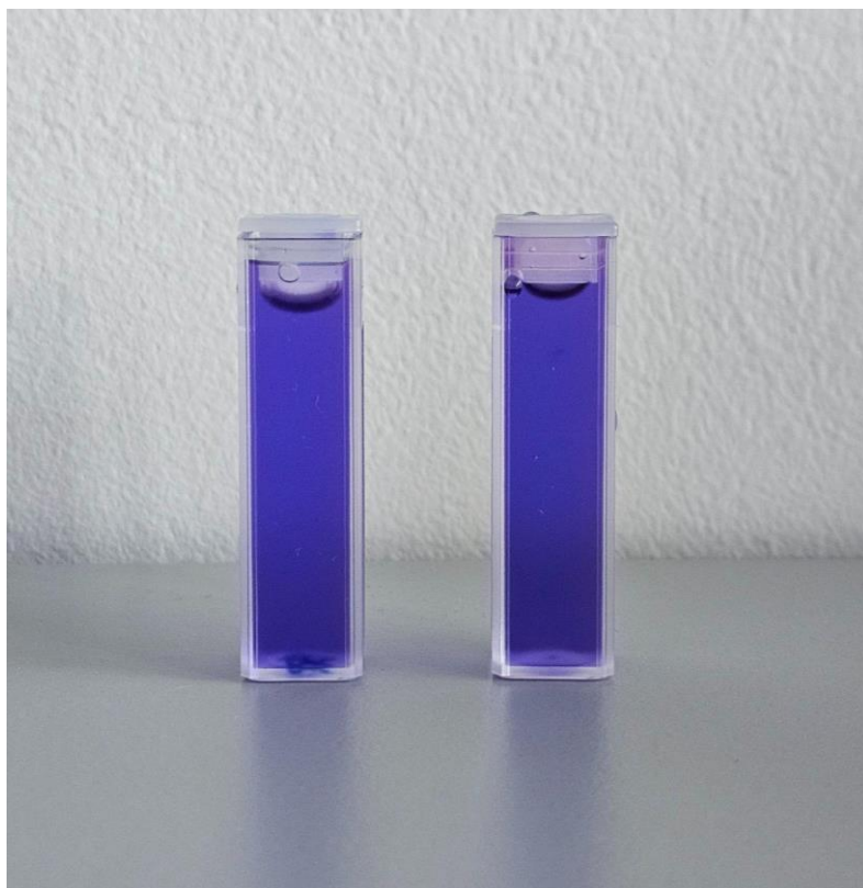
Slika 20: Kiveta ZnO+MB+RhB (kiveta sa zvjezdicom, lijevo) i kontrolni uzorak prije postavljanja ispod UV-lampe ( t = -30 min)
