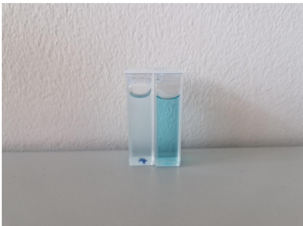
Slika 24: kiveta ZnO+MB (kiveta sa zvjezdicom, lijevo) i kontrolni uzorak (desno) na kraju mjerenja ( t = 110 min)
