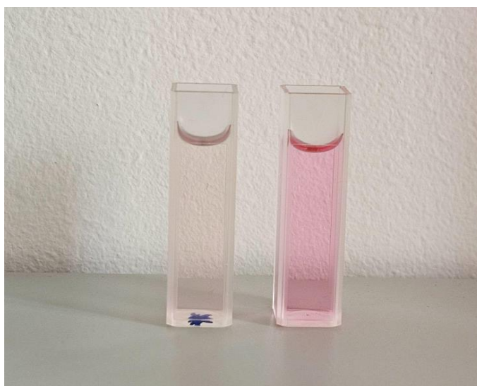
Slika 18: Kiveta sa cinkovim oksidom (kiveta sa zvjezdicom, lijevo) i kontrolni uzorak nakon 54.4 minuta ispod UV-lampe ( t = 54.4 min)
