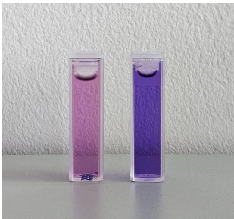
Slika 21: Kiveta ZnO+MB+RhB (kiveta sa zvjezdicom, lijevo) i kontrolni uzorak nakon 70 minuta ispod UV-lampe ( t = 70 min)
