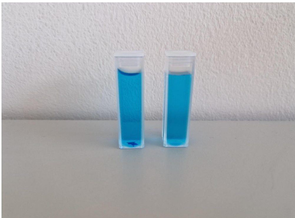
Slika 23: kiveta ZnO+MB (kiveta sa zvjezdicom, lijevo) i kontrolni uzorak (desno) prije stavljanja pod solarnu lampu ( t = -30 min)
