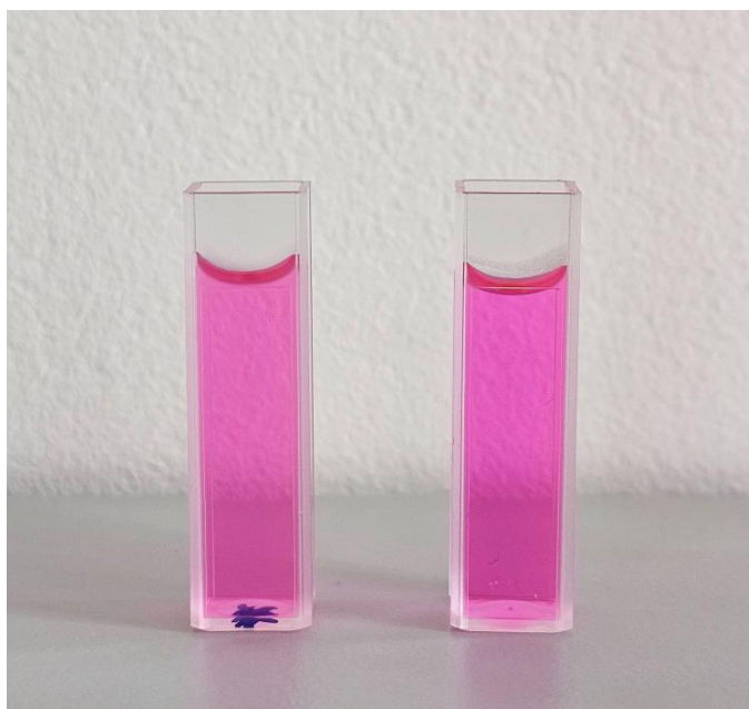
Slika 17: Kiveta sa cinkovim oksidom (kiveta sa zvjezdicom, lijevo) i kontrolni uzorak prije postavljanja ispod UV-lampe ( t = -30 min)
