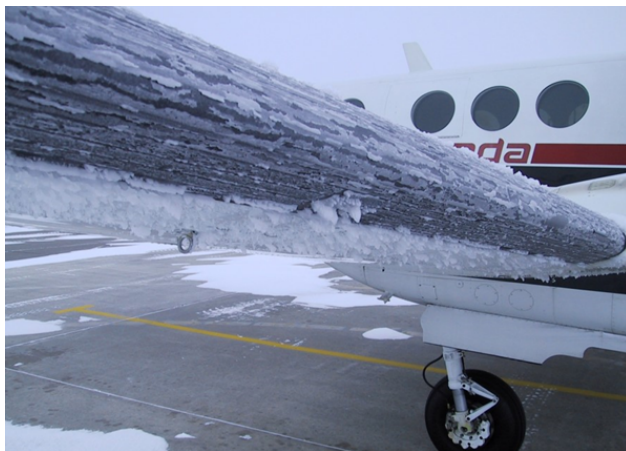
Slika 1: Zaleđivanje dijelova zrakoplova. Izvor: http://pilotgetaways.com/mag/nd09/icing .
