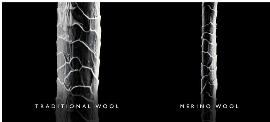
Slika 5. Mikroskopska snimka vunениh vlakana različite finoće
