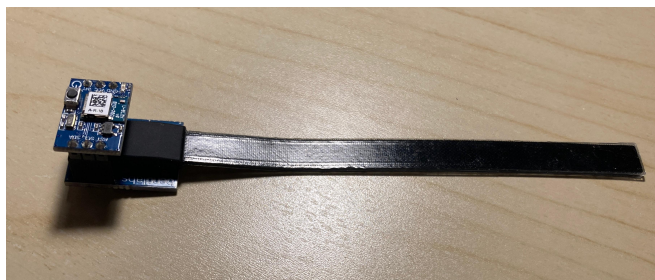
Slika 2.2: Korišteni senzor savijanja, Bend Labs 1-axis flex sensor
