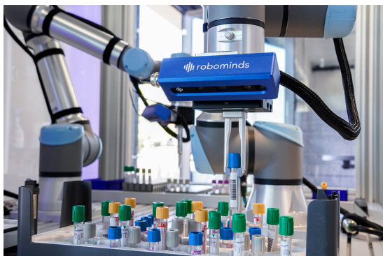
Slika 2.7: Sortiranje uzoraka krvi pomoću UR robotske ruke [19]
