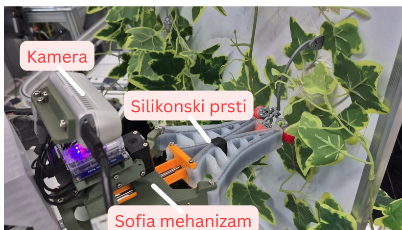
Slika 5.2: Hvataljka i njeni dijelovi
