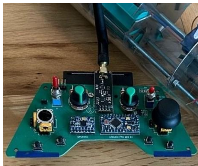
Slika 4. a) PCB – kontroler; b) Realna izvedba kontrolera
