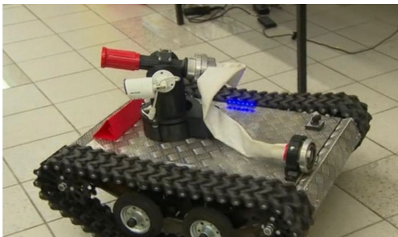
Slika 37. Ispitivanje sustava s montiranom okretnom kupolom
