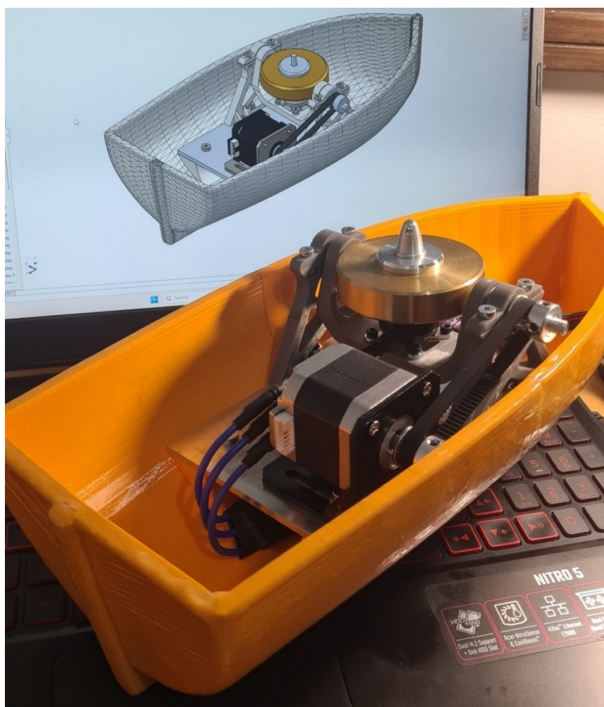
Slika 124. Sastavljeni model giroskopskog stabilizatora u maketi broda
