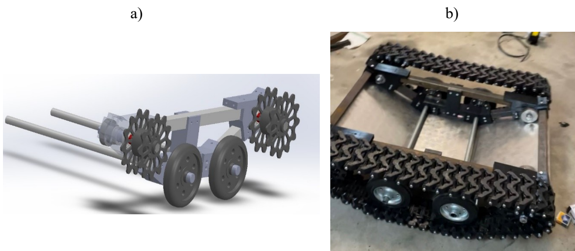
Slika 32. a) CAD model; b) Pogonski sklop
