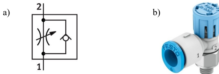
Slika 62. a) Pneumatski simbol prigušno-nepovratnog ventila [38]; b) Prigušno - nepovratni ventil VFOE-LS-T-M5-Q6 [38]
