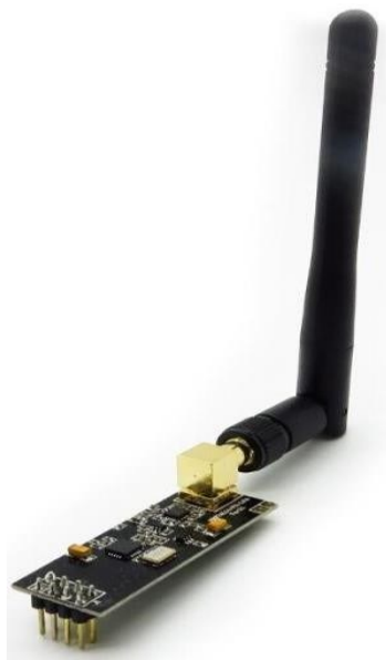
Slika 6. Izgled modula nRF24L01 s pojačalom i antenom
