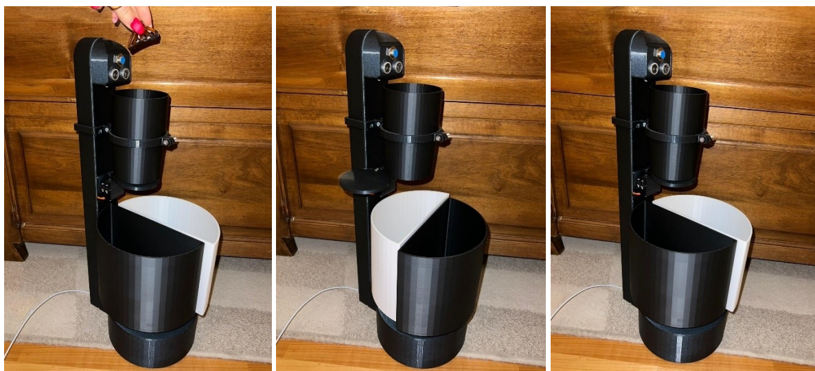
Slika 79. Umetanje plastičnog predmeta, rotiranje bijele posude, neutralni položaj
