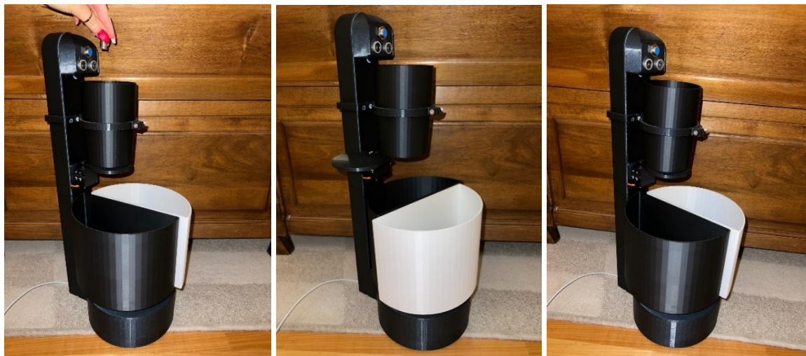
Slika 80. Umetanje metalnog predmeta, rotiranje crne posude, neutralni položaj
