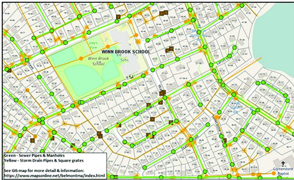
Slika 6. Shema kanalizacijske mreže u Belmontu, Massachusetts [26]
