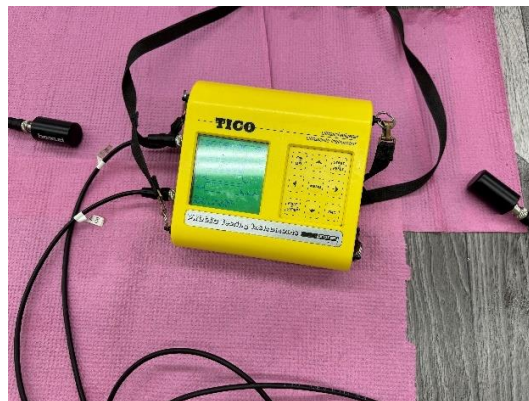
Slika 17. Uređaj za mjerenje vremena prolaska ultrazvučnog vala
