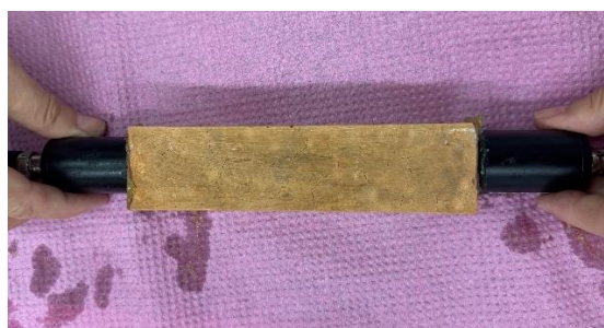
Slika 18. Položaj sonde pri mjerenju brzine prolaska ultrazvuka
