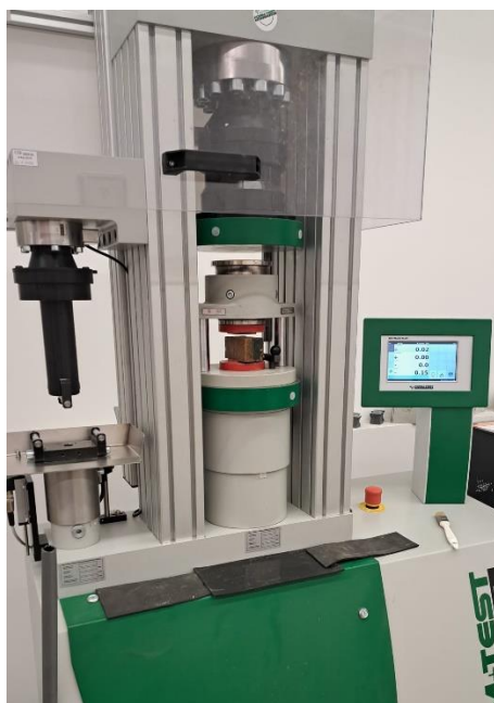
Slika 15. Hidraulična preša za ispitivanje vlačne i tlačne čvrstoće
