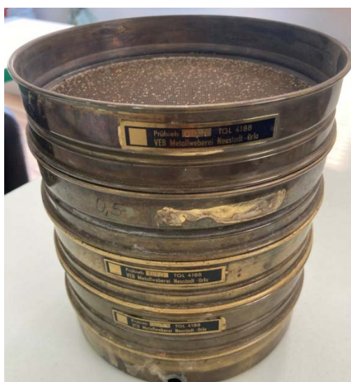
Slika 4-4. Sita korištena za prosijavanje željenih frakcija praha kore mandarine
