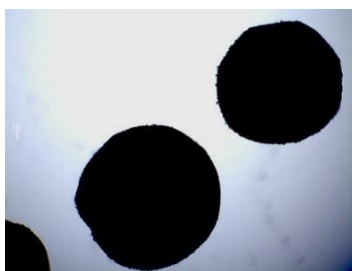
Slika 15. Mikrografija kristala dobivenih kombiniranom metodom za sustav CRT+THF–voda+PVP (1 % w/w) –heptan pri uvećanju 40x, n=550 \text{ min}^{-1} i t=60 \text{ min} .
