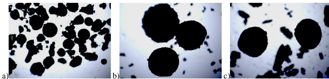
Slika 14. Mikrografije kristala dobivenih metodom kvazi–emulzijske difuzije otapala pri uvećanju 100x, n=550 \text{ min}^{-1} i t=60 \text{ min} za: a) CRT+THF–voda+PVP (1 % w/w) b) CRT+THF–voda+PVP (3 % w/w) i c) CRT+THF–voda+PVP (5 % w/w).
