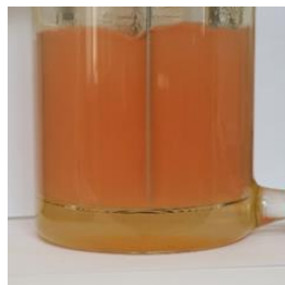
Slika 24. Sustav heptan-voda pri kritičnoj brzini miješanja određenoj just dispersed kriterijem.
