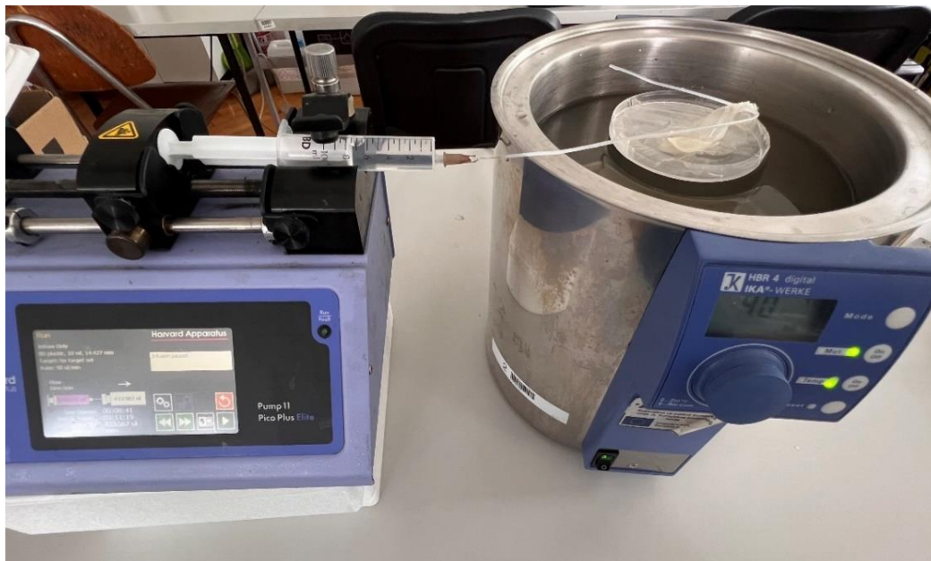
Slika 11. Aparatura za provedbu biotransformacije s imobiliziranim enzimom u teflonskom cijevnom mikroreaktoru (vlastita fotografija)
