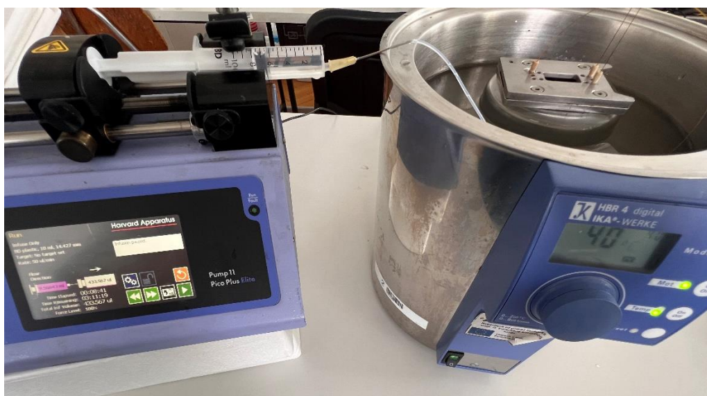
Slika 10. Aparatura za provedbu biotransformacije s imobiliziranim enzimom u staklenom mikroreaktoru (vlastita fotografija)
