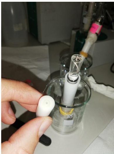
Slika 5. Montiranje senzorske membrane na tijelo elektrode
