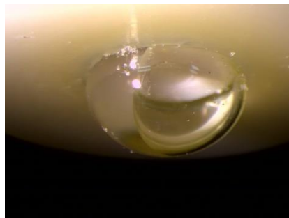
Slika 6. Uvećana slika vršnog dijela senzora koji je ispunjen unutrašnjim elektrolitom te je vidljiv i mjehurić zraka
