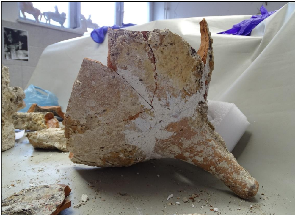
Slika 29: Prijašnje nadoknade nedostajućih dijelova bijelom žbukom, fragmenti br. 58, 40 i 37 (fotografirala: Sara knežević, siječanj 2023.)
