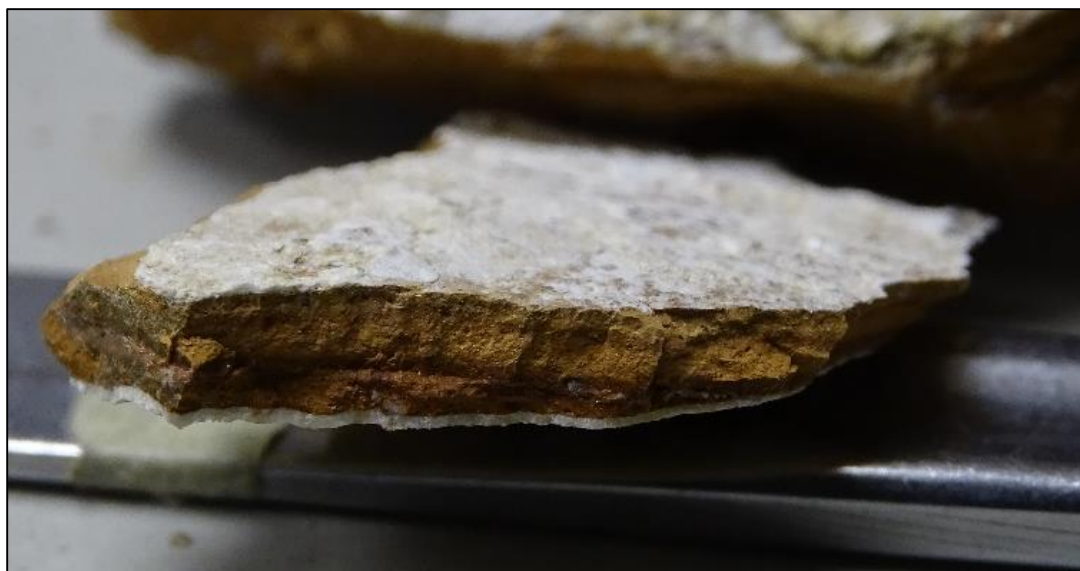
Slika 24: Kristalizirane soli na donjem dijelu fragmenta br. 15, (fotografirala: Sara Knežević prosinac 2022.)
