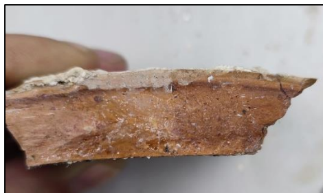
Slika 33: Fragment nakon uklanjanja sjajnog ljepila s Paramose industrial paint and varnish remover-om (fotografirala: Sara Knežević, siječanj 2023.)
