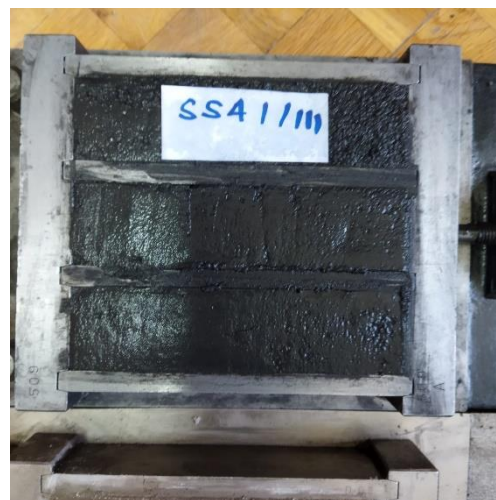
Slika 6 Kalupi ispunjeni mješavinom za izradu uzorka M3
