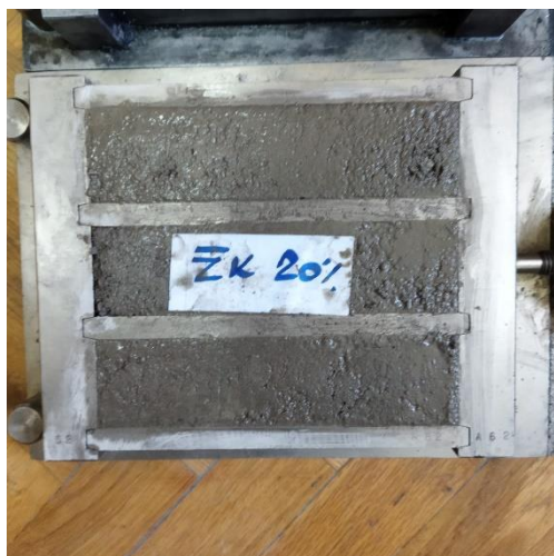
Slika 5 Kalupi ispunjeni mješavinom za izradu uzoraka M1 i M2
