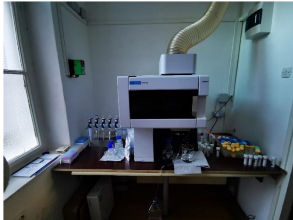
Slika 14 Sustav za provođenje ICP analize smješten u laboratoriju Zavoda za hidrotehniku Građevinskog fakulteta Sveučilišta u Zagrebu
