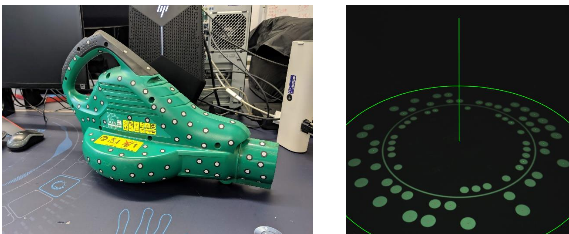
Slika 40. Praćenje markera na objektu (lijevo) i okretnom stoliću (desno)
