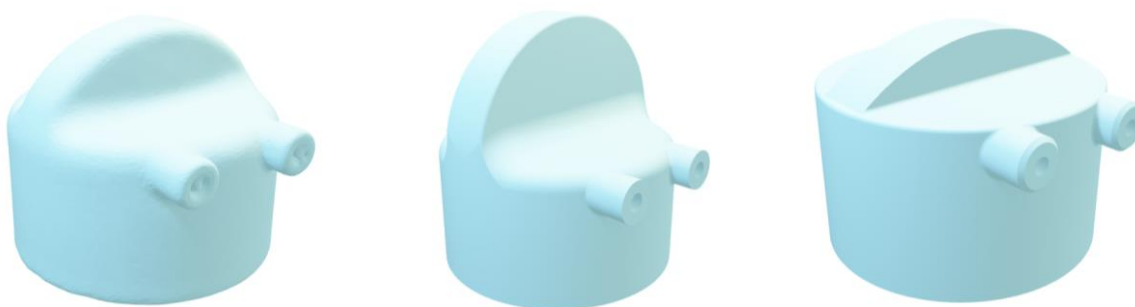
Slika 77. Skenirana komponenta (lijevo) i modelirana komponenta (sredina i desno)
