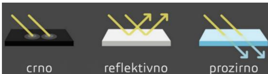
Slika 29. Utjecaj površine na projicirano svjetlo
