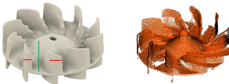
Slika 78. Primjer komponente s pravilnim izborom orijentacije skenera
