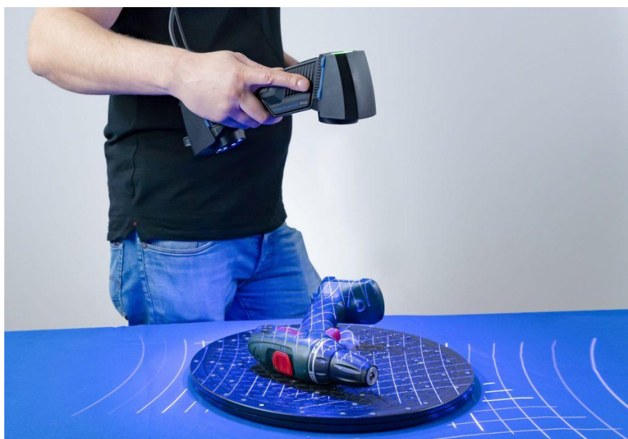
Slika 4. Ručno skeniranje laserskim 3D skenerom [9]
