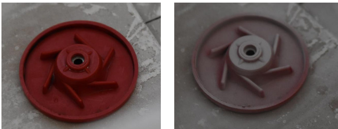
Slika 30. Sprejom ne pripremljena (lijevo) i pripremljena komponenta (desno)
