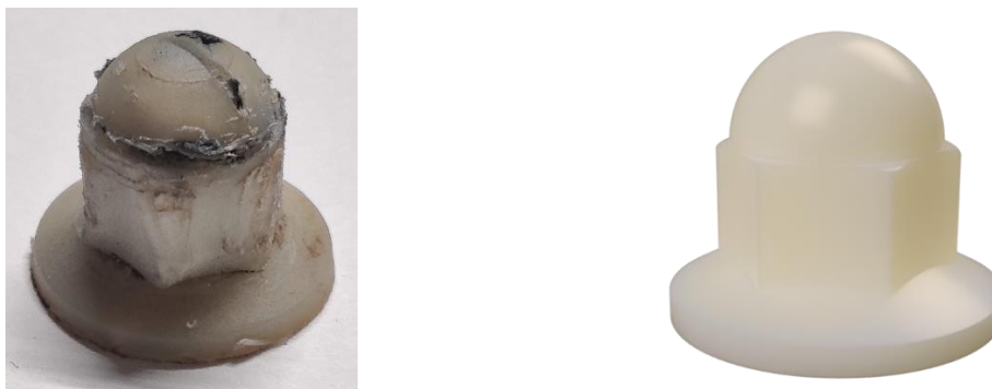
Slika 23. Rastavljanjem uništena komponenta i njezin računalni prikaz
