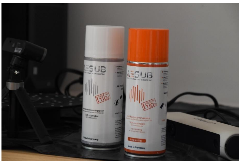
Slika 80. Običan (lijevo) i sublimirajući (desno) sprej za skeniranje
