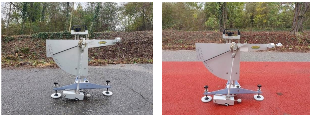
Slika 9. Mjerenje pomoću Matest A113 uređajem na podlogama za ispitivanje
