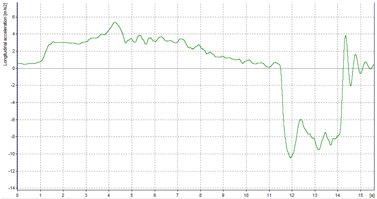
Prilog 7: Grafički prikazi promjene longitudinalne i lateralne akceleracije pri brzini od 80 km/h na suvremenom kolničkom asfaltnom zastoru u suhim uvjetima
