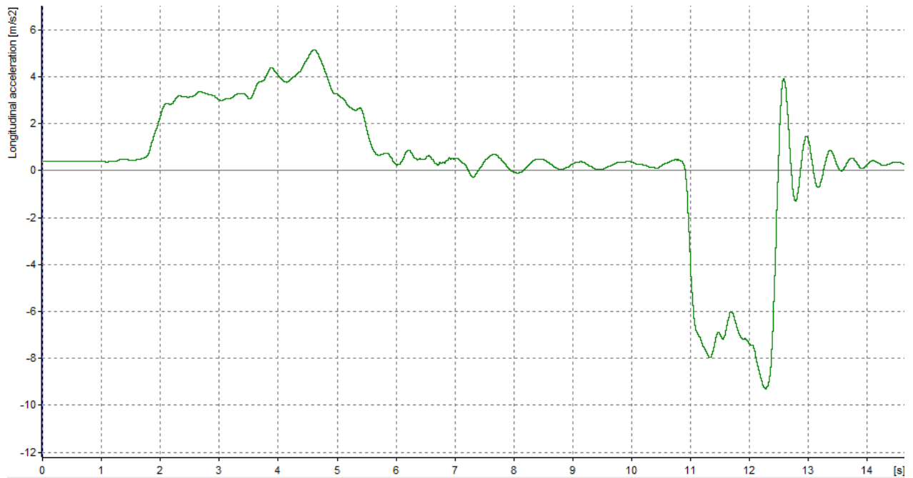
Prilog 9: Grafički prikazi promjene longitudinalne i lateralne akceleracije pri brzini od 40 km/h na suvremenom kolničkom asfaltnom zastoru u kišnim uvjetima
