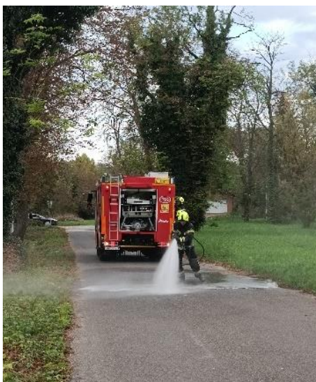
Slika 11. Stvaranje kišnih uvjeta za provedbu ispitivanja od strane Javne vatrogasne postrojbe Grada Zagreba
