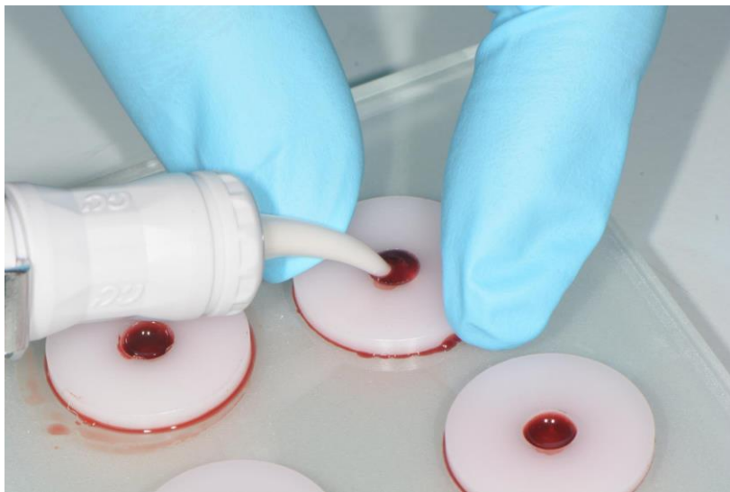
Slika 14. Istiskivanje zamiješanog materijala iz kapsule u teflonski kalup s humanom krvju na staklenoj podlozi
