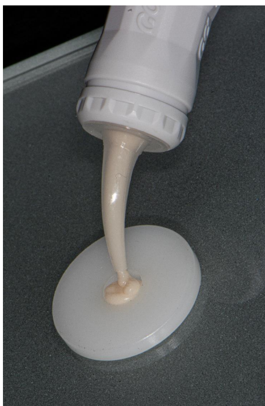
Slika 5. Istiskivanje zamiješanog materijala iz kapsule u teflonski kalup na staklenoj podlozi
