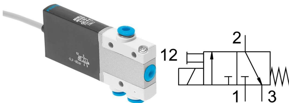
Slika 3.7. Ventil Festo MHE2-MS1H-3/2G-QS-4-K i njegova pneumatska shema [17]
