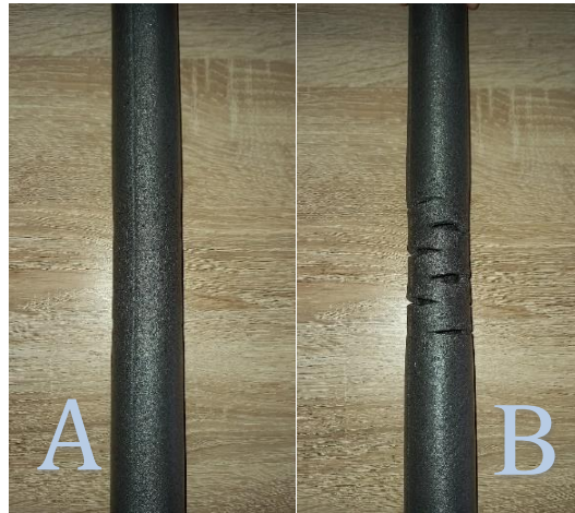
Slika 3.12. (A) Nosač -neopterećen, (B) Nosač -opterećen uzdužnom vlačnom silom
