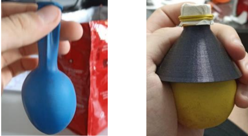
Slika 5.17. Montaža fleksibilne hvataljke
