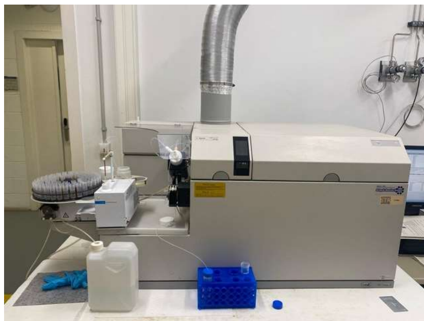
Slika 4. Maseni spektrometar s induktivno spregnutom plazmom Agilent 7500c (Agilent Technologies, Santa Clara, CA, SAD).
