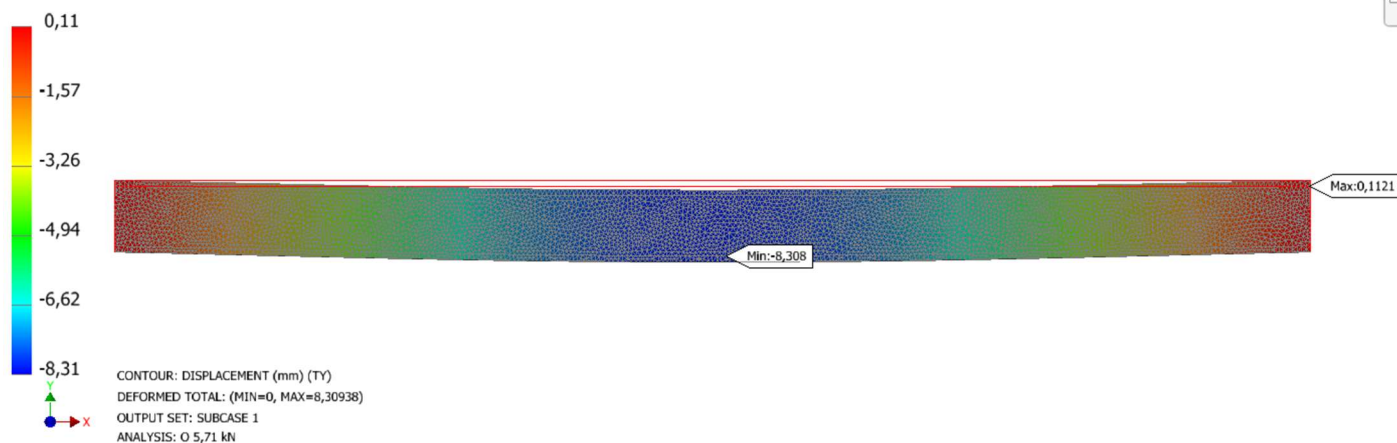
Slika 37 Deformacija uzorka O pri 5,71 kN
