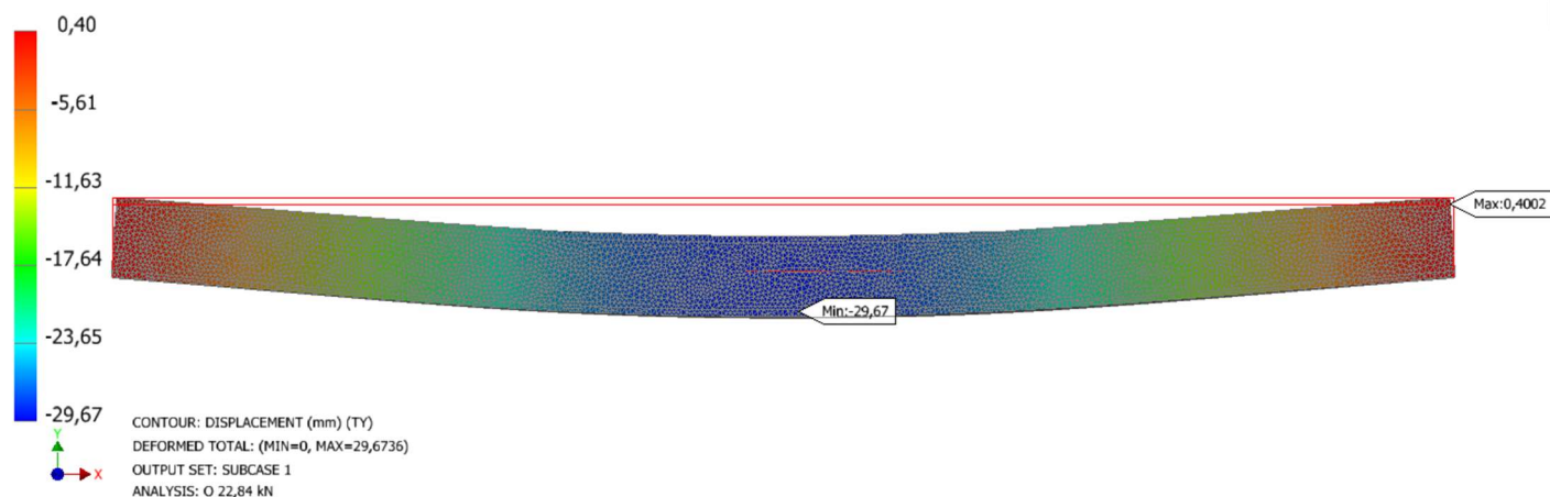
Slika 35 Deformacija uzorka O pri 22,84 kN
