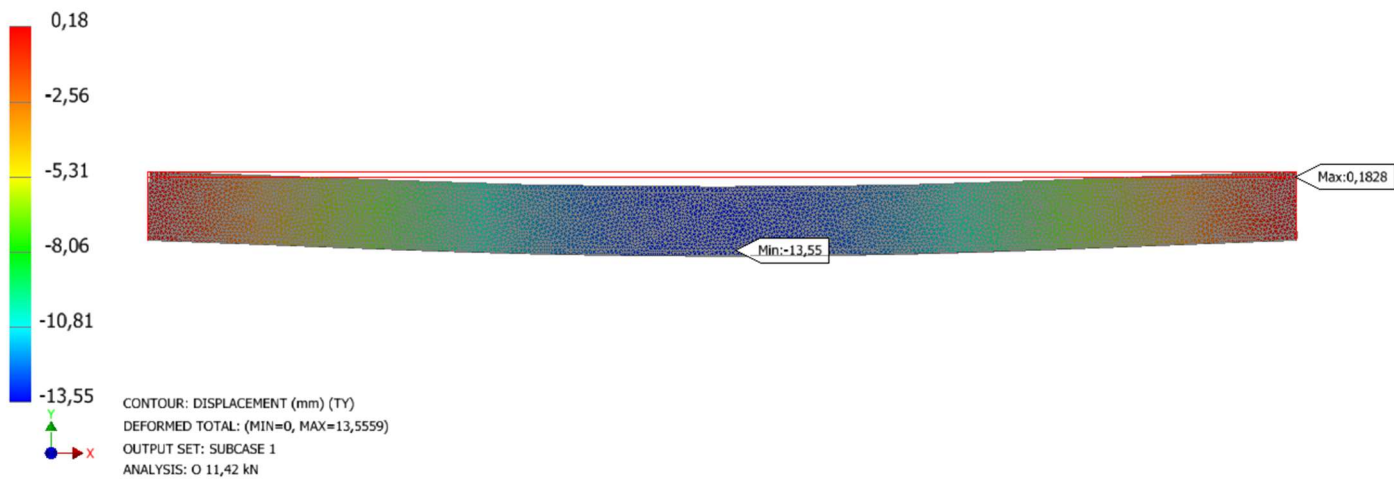
Slika 36 Deformacija uzorka O pri 11,42 kN
