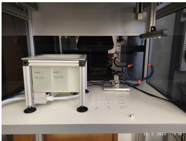
Slika 16. Robot za pripravu polielektrolitnih višeslojeva Dip coating robot DR-3 proizvođača Riegler & Kirstein GmbH.
