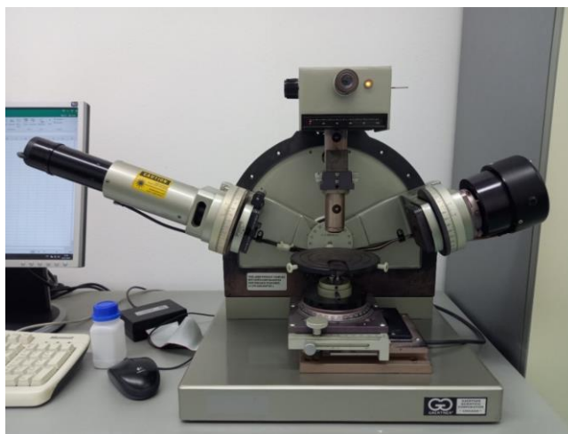
Slika 19. Elipsometar proizvođača Gaertner , model: L116B-USB.
