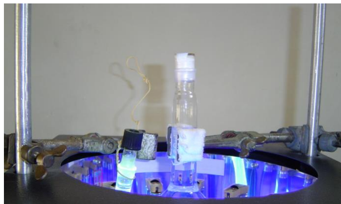
Slika 29. Fotokemijski reaktor Rayonet korišten za sintezu tienobenzo/naftotriazola 15-22 .
