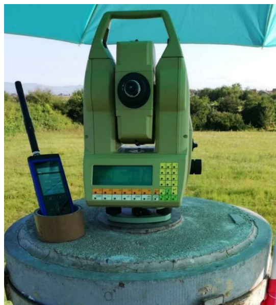
Slika 9. Precizna geodetska mjerna stanica i uređaj za mjerenje atmosferskih parametara.
