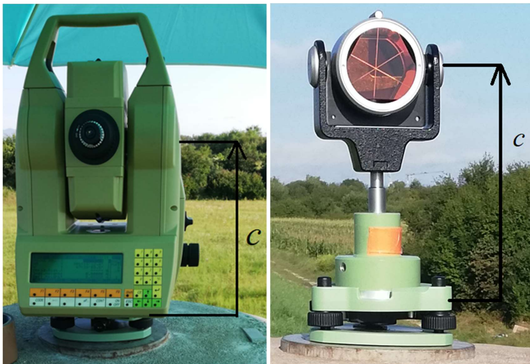
Slika 17. Veličine c za geodetsku mjernu stanicu i preciznu prizmu.
