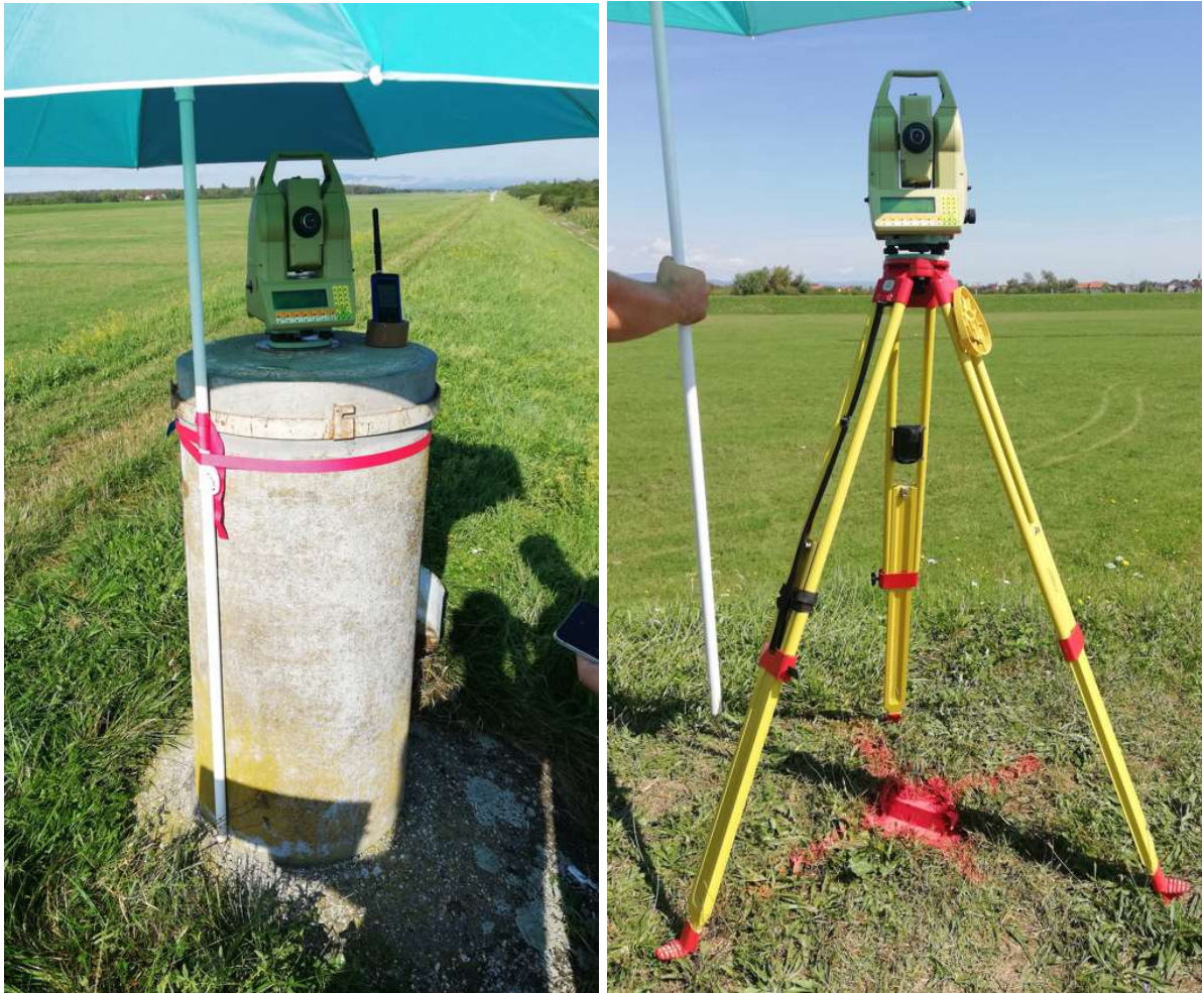
Slika 20. Leica TC2003 postavljena na geodetski stup (lijevo) i stativ (desno).
