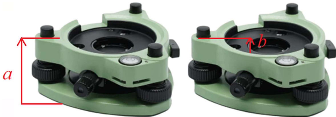
Slika 16. Veličine a i b izmjerene na podnožnim pločama.
