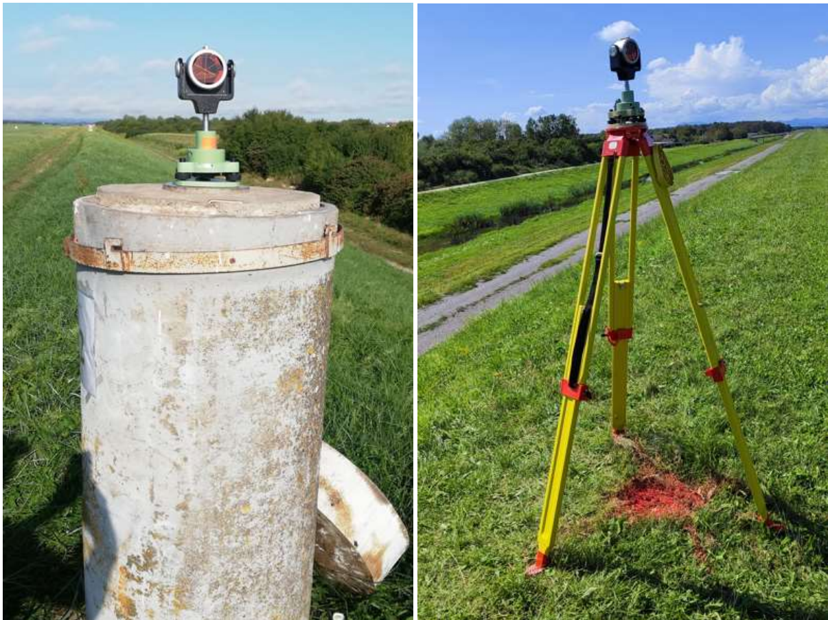
Slika 19. Prizma postavljena na geodetski stup (lijevo) i stativ (desno).
