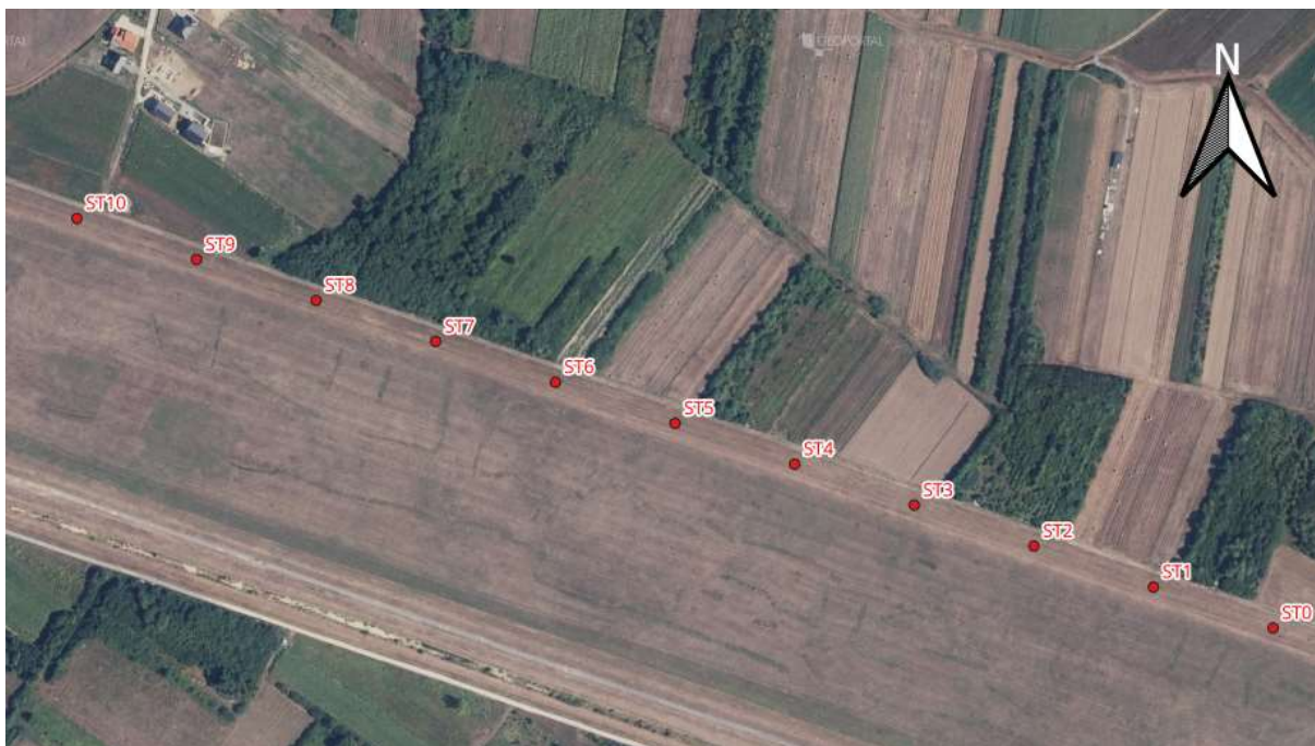
Slika 4. Položaj stupova kalibracijske baze.
