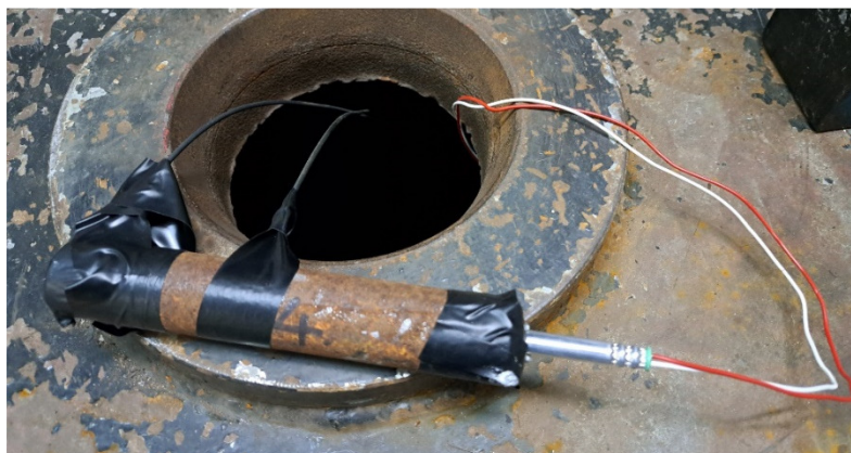
Slika 6-6. Fotografija mjernog postava u čeličnoj cijevi unutarnjeg promjera \varnothing 23,5 mm.
