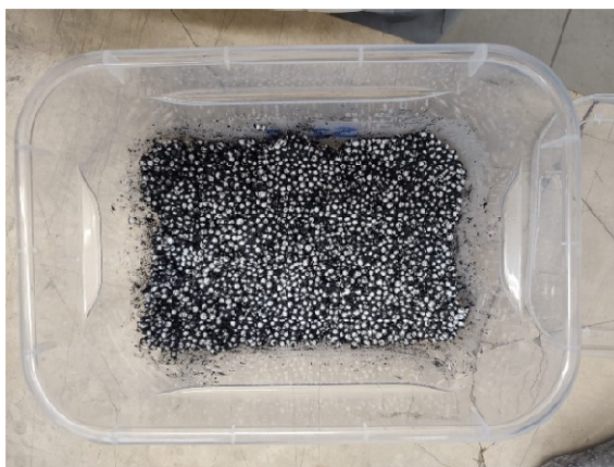
Slika 6-5. Fotografija emulzijskog eksploziva smanjene gustoće s dodatkom 10 % reciklirane gume.
