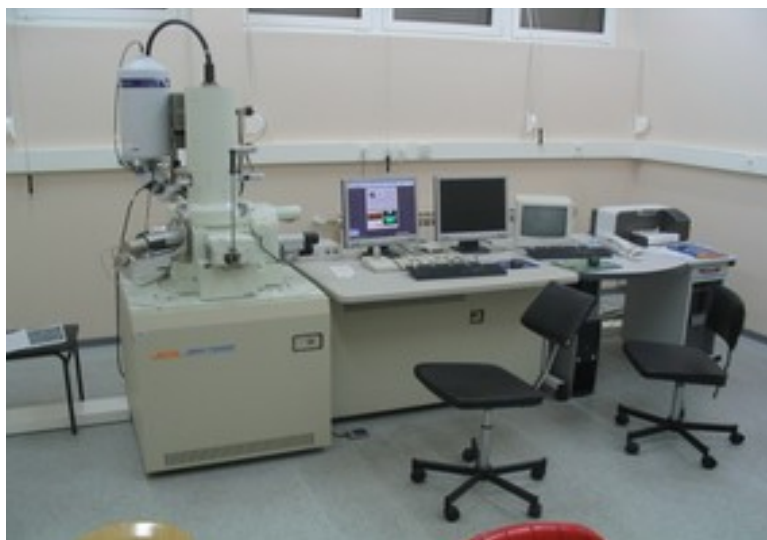
Slika 5. Pretražni elektronski mikroskop JSM 7000F (JEOL, Japan) sa spektroskopom karakterističnog X-zračenja INCA-350 (Oxford Instruments, Engleska)
