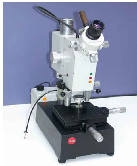
Slika 3. Uređaj za mjerenje mikrotvrdoće (Leitz Miniload 2 Microhardnes Tester, Njemačka)
