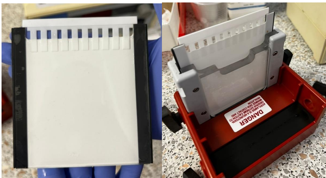
Slika 3.5. S lijeve strane prikazan je kalup za gelove sastavljen od neprozirnog i prozirnog stakalca, češljica i razmaknice; s desne strane prikazan je isti kalup fiksiran u postolju za polimerizaciju gelova.
