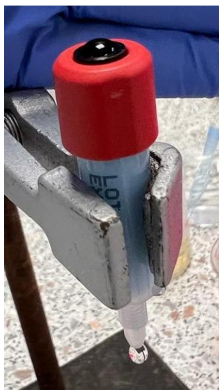
Slika 3.4. HisTrap kolona za pročišćavanje HHHH proteina afinitetnom kromatografijom
