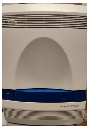
Slika 3.9. Uređaj 7500 Real Time PCR System (Applied Biosystems, SAD) za određivanje termičke stabilnosti proteina
