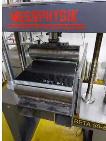
Slika 35. Testiranje savijanja u 3 točke
