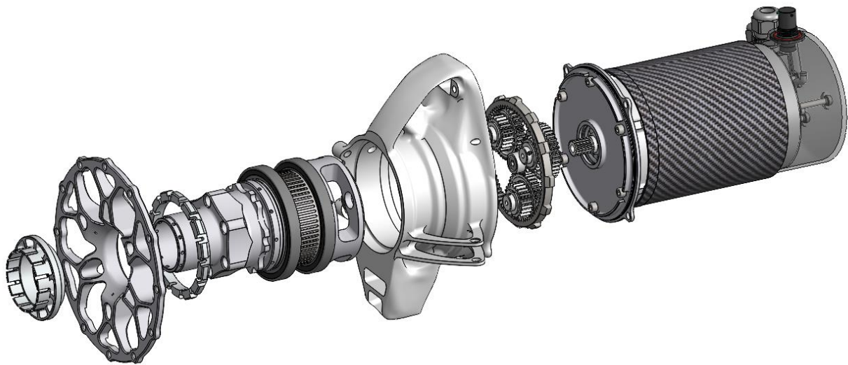
Slika 119: Sklop stražnjeg kotača s pogonskim sklopom
