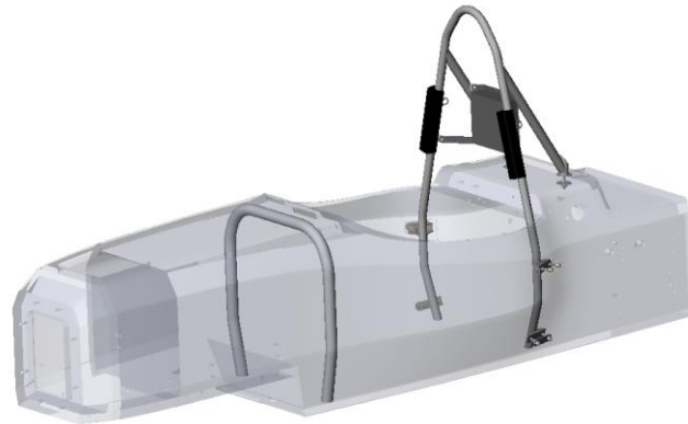
Slika 45. Izgled glavnog obruča i prednjeg obruča unutar šasije
