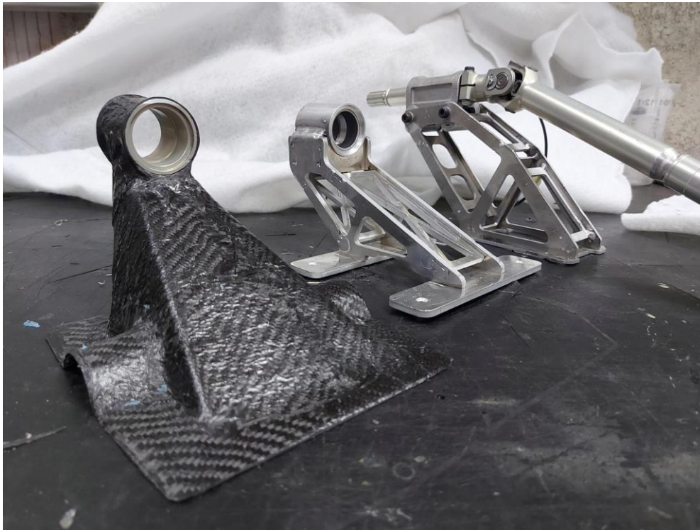
Slika 125. Usporedba nosača volana bolida FSB-RT06R i FSB-RT07
