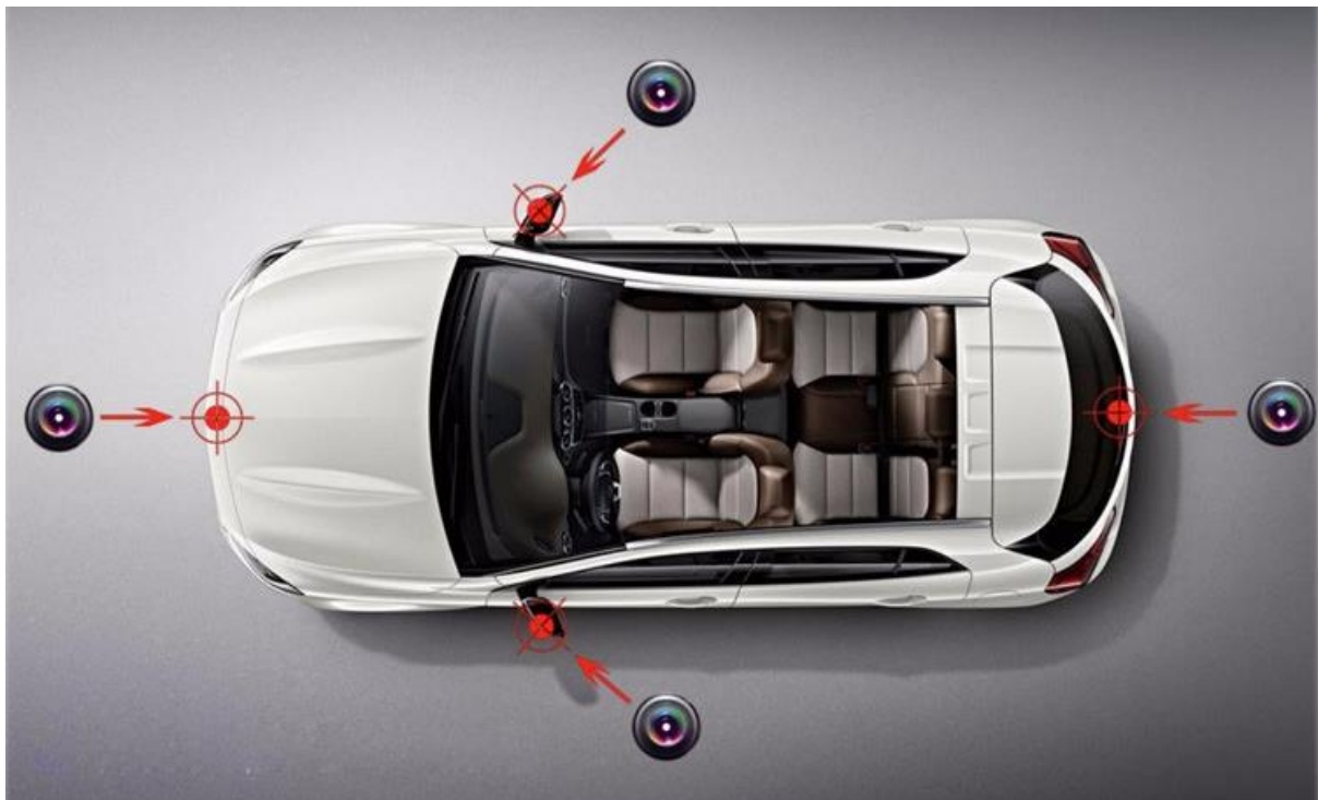
Slika 2. Položaj 360° kamera u automobilu [15]
