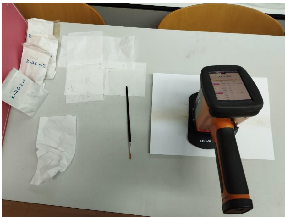
Slika 2. Izvođenje mjerenja instrumentom za rendgensku fluorescencijsku analizu (pXRF) Hitachi XMET 8000 Expert Geo
