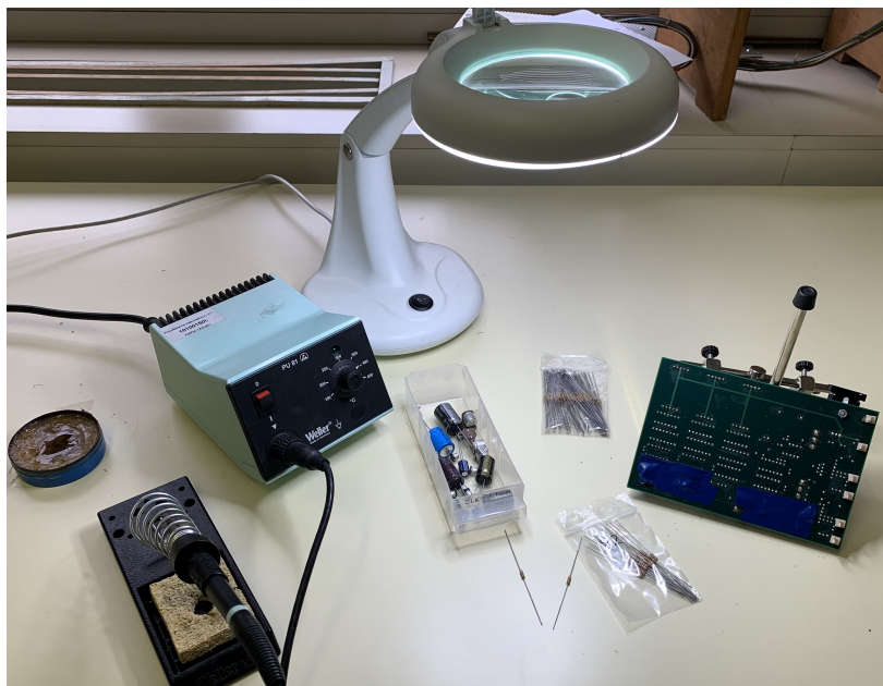
Slika 6: Lemljenje elektroničkih komponenti na printanu pločicu za obradu podataka.
