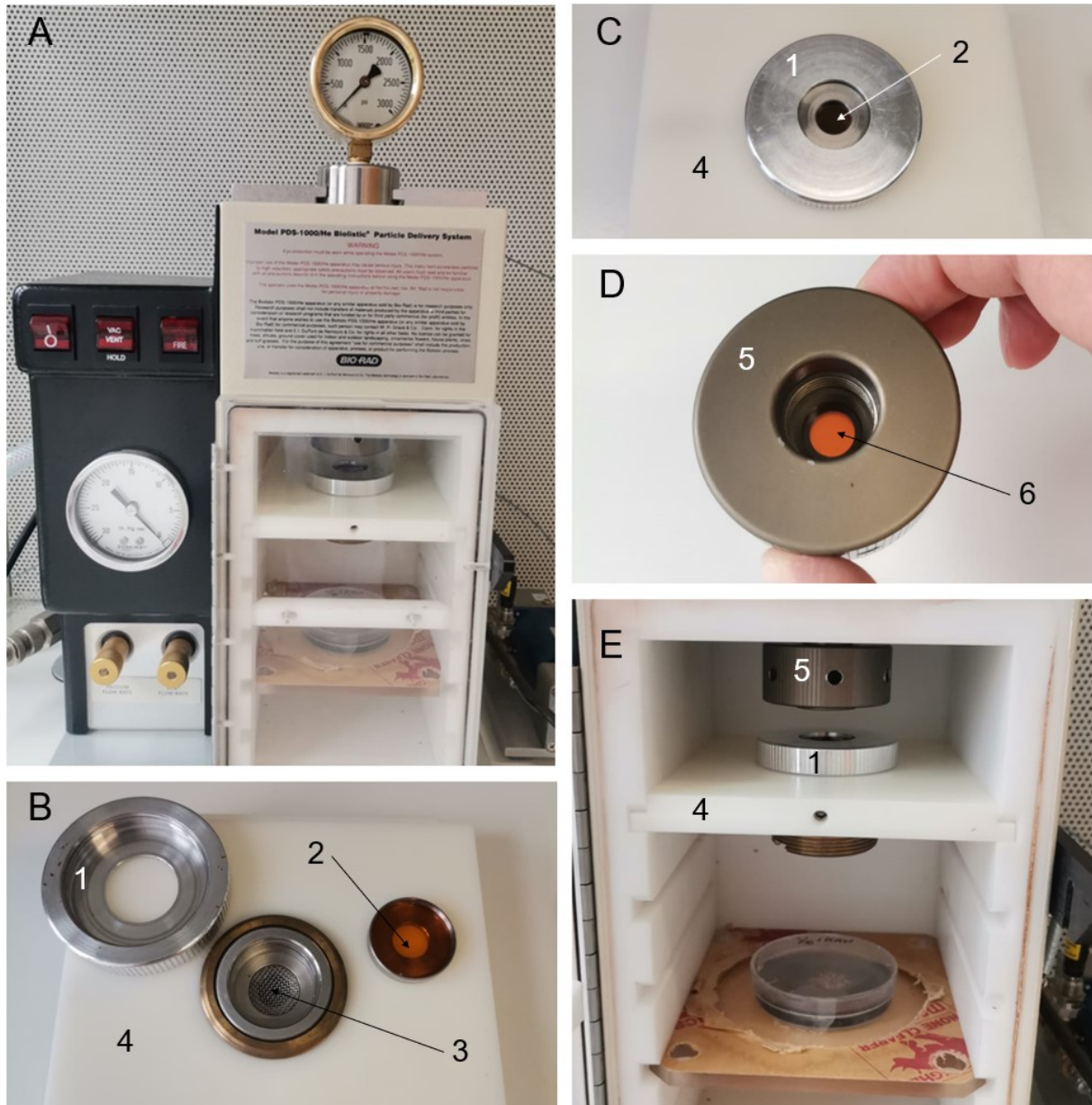
Slika 3.16.3.1. Komponente uređaja za biolistiku VvPDS-100/He Biolistic Particle Delivery System (Bio-Rad, Hercules, California, SAD). Vanjski izgled postavljenog uređaja (A). Postavljanje uređaja (B, C, D i E): Na makronosač (2) se nanosi 10 \mu L kompleksa DNA i zlata. Potrebno je oko 10 min da se makronosač posuši. Potom mrežica za zaustavljanje (od eng. stopping screen ) (3) smješta se na svoje postolje (4), Iznad mrežice smješta se makronosač sa stranom na koju je nanosena DNA okrenutom prema mrežici. Mrežica zaustavlja dijelove makronosača, koji će puknuti uslijed visokog tlaka, da završe u tkivu. Makronosač i mrežica učvršćuju se metalnim zatvaračem (1) kao što je prikazano na slici C.
