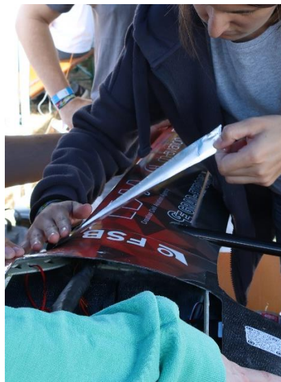
Slika 21 Ojačanje spoja trupa i krila
