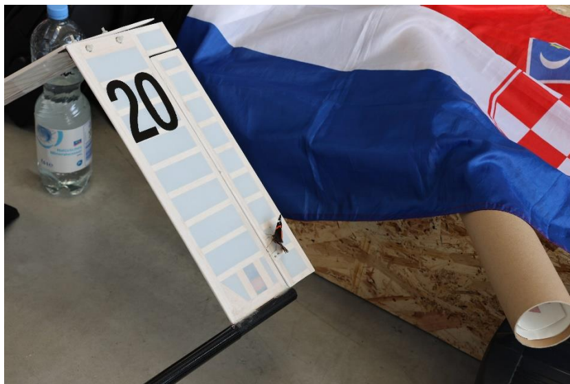
Slika 27 Izvedba repa od balze i folije
