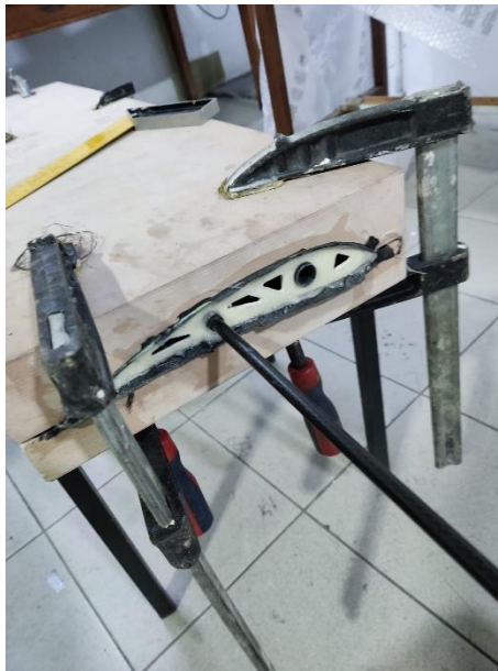
Slika 20 Izvedba korijenskog rebra krila
