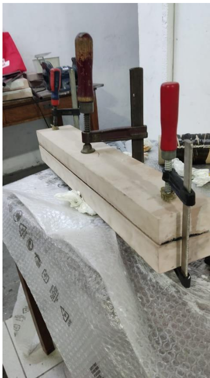
Slika 23 Postupak spajanja gornje i donje oplate zakrilaca
