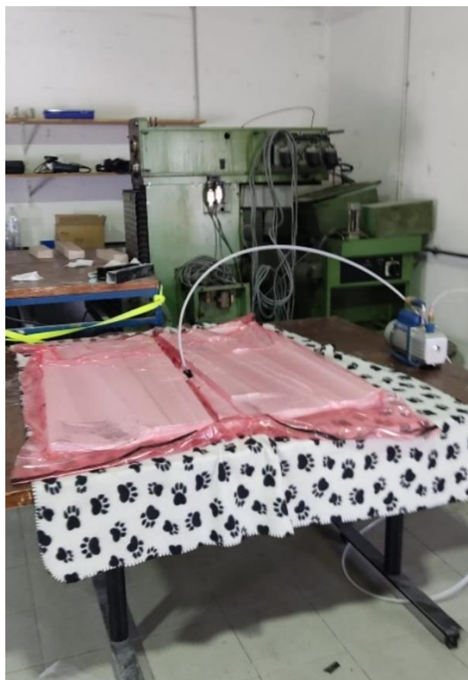
Slika 22 Izrada oplata krila postupkom vakuumiranja
