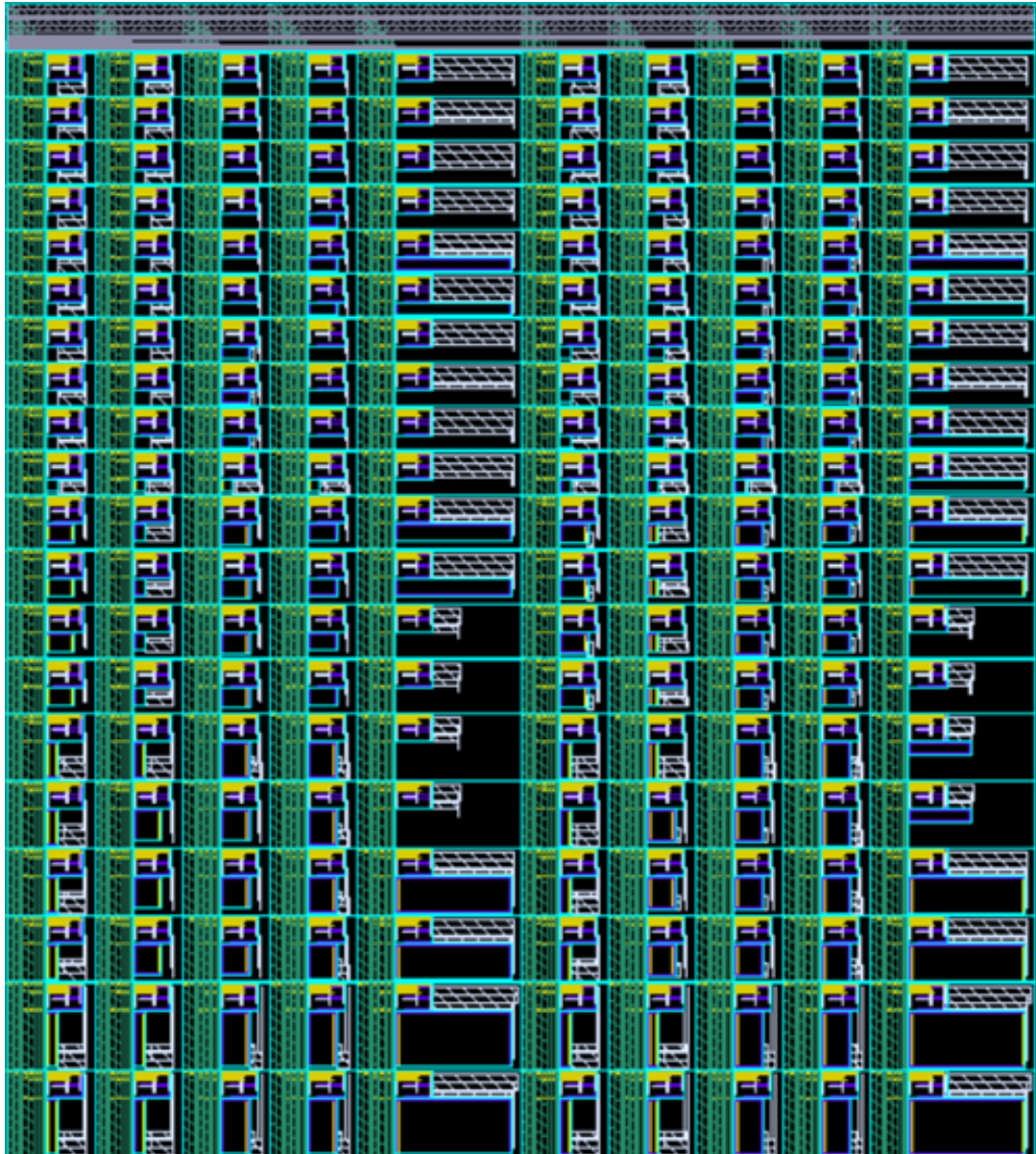
Slika 2.9: Topološki nacrt polja otporničkih ćelija.
