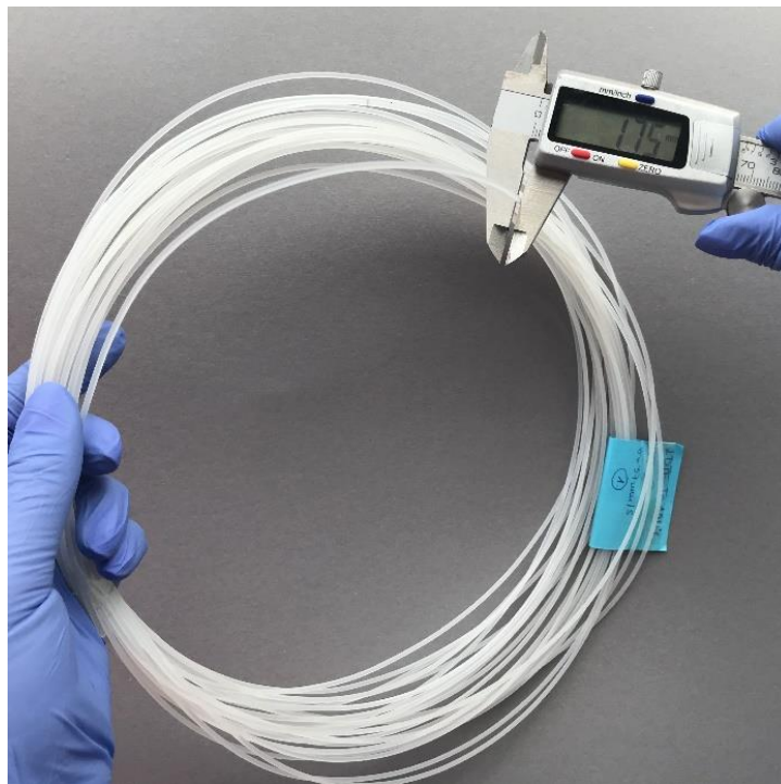
Slika 38. Mjerenje promjera filamenata pomičnom mjerkom
