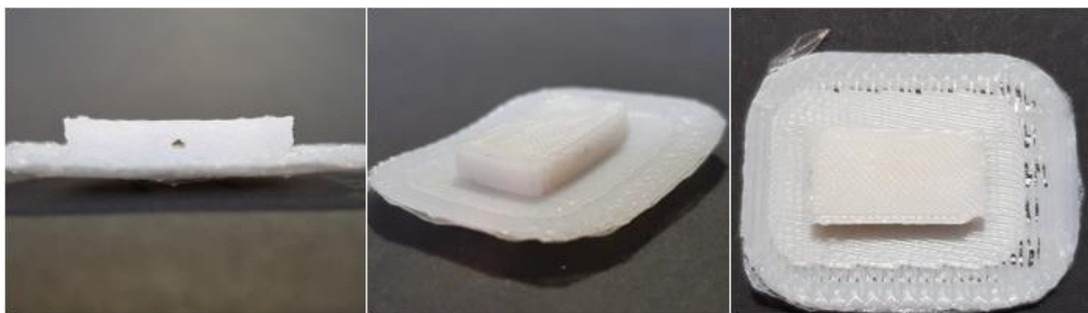
Slika 75. Primjer izrađenog modela dijela mikroreaktora korištenjem filameta PE-HD U1S2 5 %
