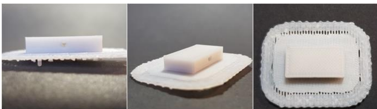
Slika 60. Primjer izrađenog modela dijela mikroreaktora korištenjem filameta Tin 1.0 ABS
