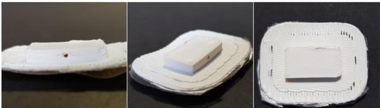
Slika 80. Primjer izrađenog modela dijela mikroreaktora korištenjem filameta PE-HD P25 15 %
