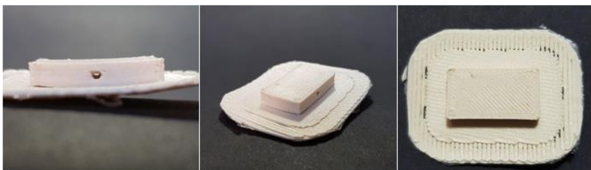
Slika 71. Primjer izrađenog modela dijela mikroreaktora korištenjem filameta PP P25 15 %
