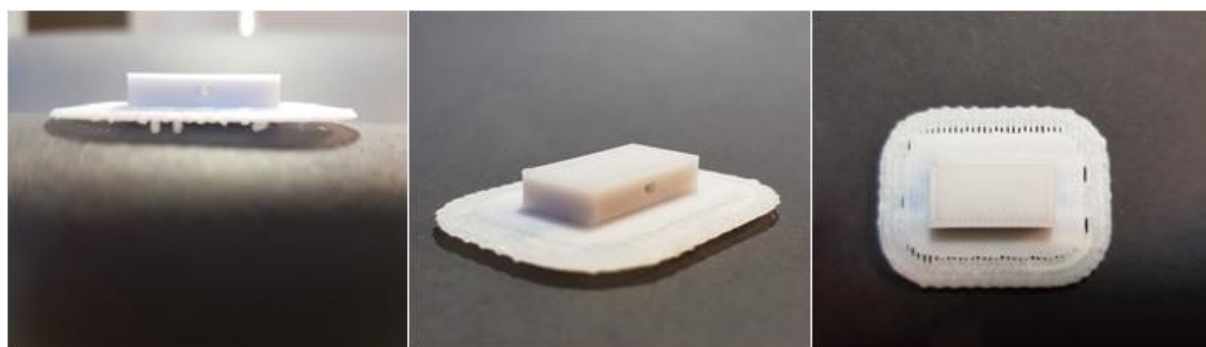
Slika 58. Primjer izrađenog modela dijela mikroreaktora korištenjem filameta Noztek ABS
