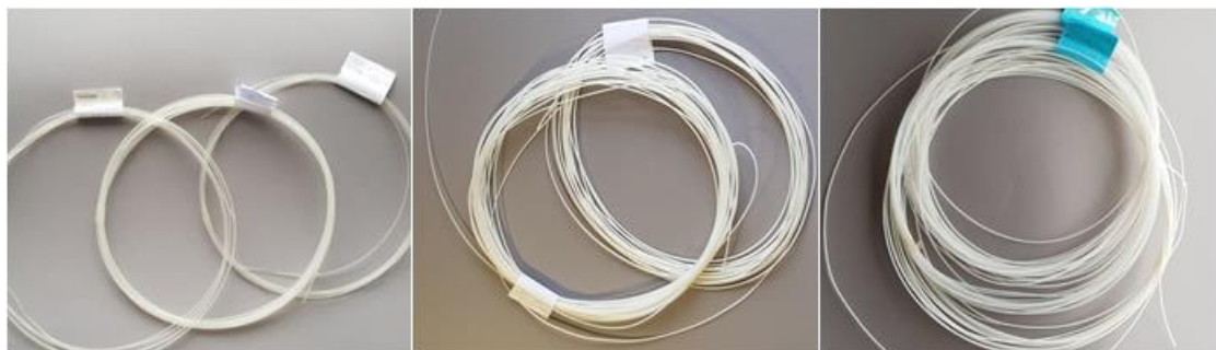
Slika 39. Primjeri pripremljenih filamenata na ekstruderu Noztek Pro i Tin 1.0
