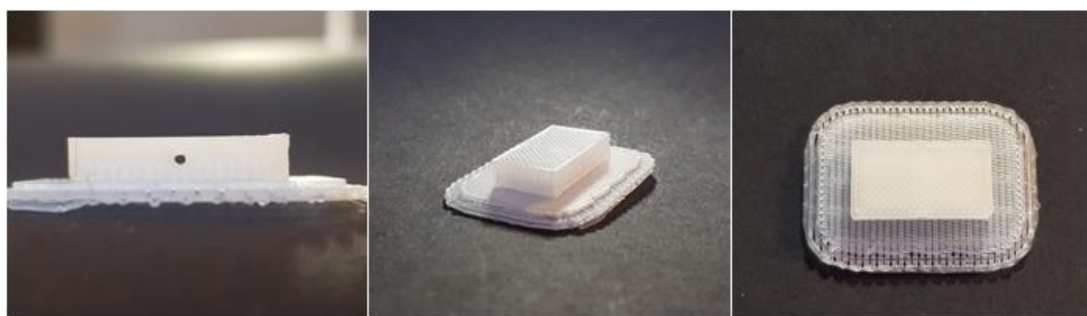
Slika 57. Primjer izrađenog modela dijela mikroreaktora korištenjem filameta Noztek PLA
