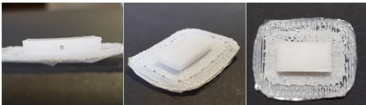
Slika 62. Primjer izrađenog modela dijela mikroreaktora korištenjem filameta Tin 1.0 PP
