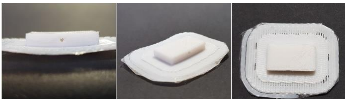
Slika 68. Primjer izrađenog modela dijela mikroreaktora korištenjem filameta PP U1S2 15 %
