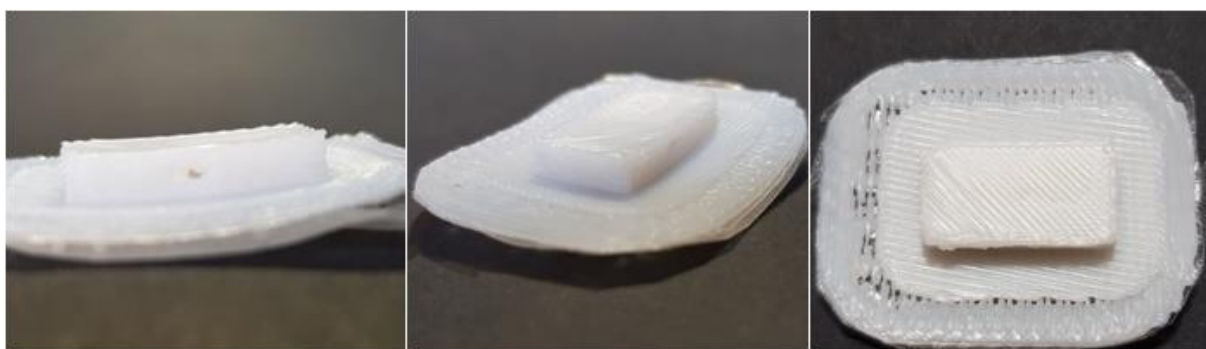
Slika 77. Primjer izrađenog modela dijela mikroreaktora korištenjem filameta PE-HD U1S2 15 %
