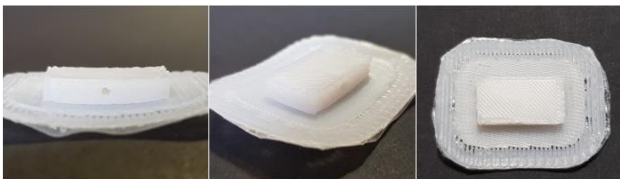
Slika 61. Primjer izrađenog modela dijela mikroreaktora korištenjem filameta Tin 1.0 PE-HD
