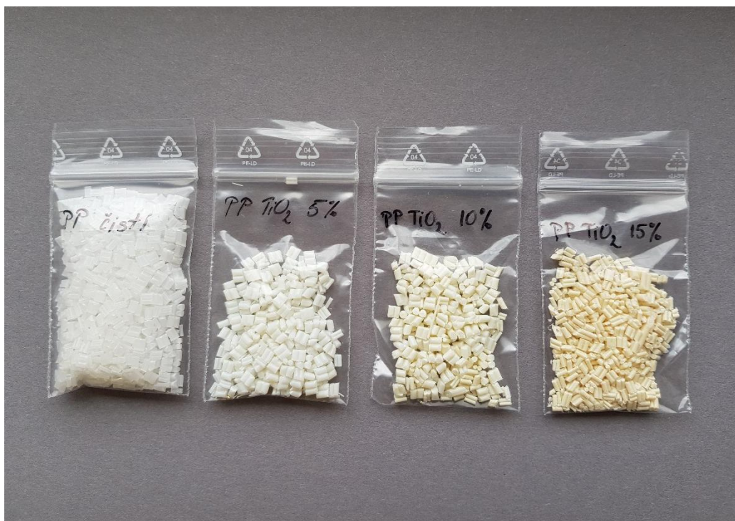
Slika 34. Granule referentnog uzorka PP i pripremljenih PP kompozita sa funkcionalnim punilom \text{TiO}_2 P25
