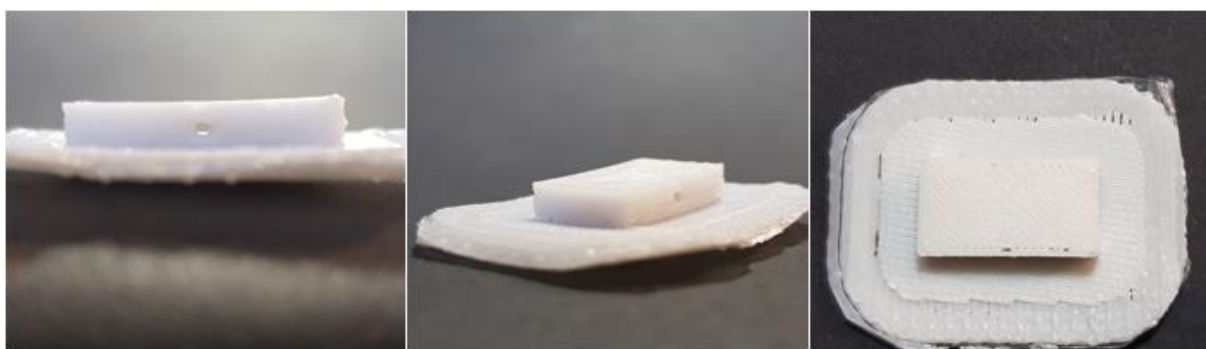
Slika 65. Primjer izrađenog modela dijela mikroreaktora korištenjem filameta PP U1 15 %
