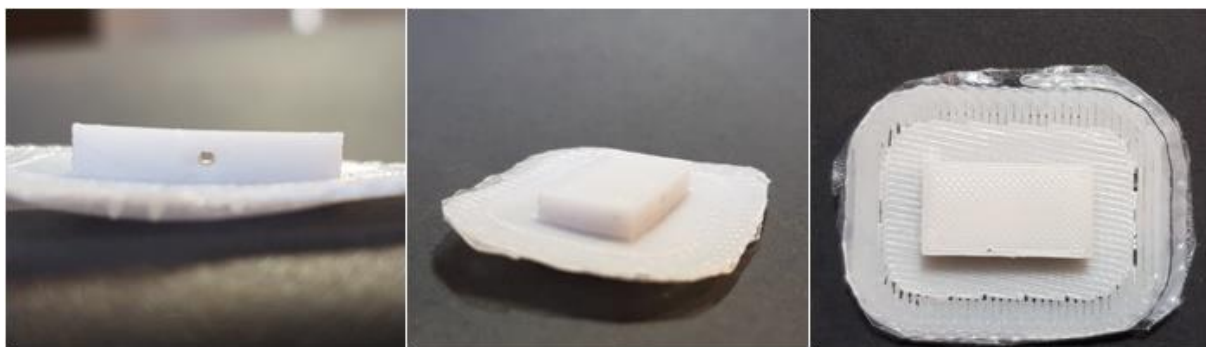
Slika 66. Primjer izrađenog modela dijela mikroreaktora korištenjem filameta PP U1S2 5 %
