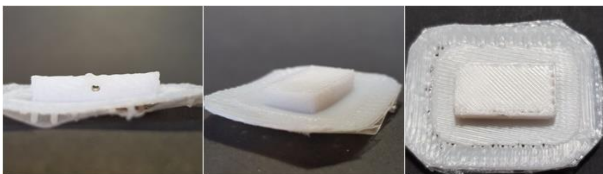
Slika 76. Primjer izrađenog modela dijela mikroreaktora korištenjem filameta PE-HD U1S2 10 %
