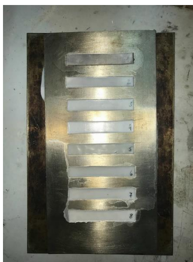
Slika 17. Isprešani uzorci kompozita za mjerenje kontaktnog kuta
