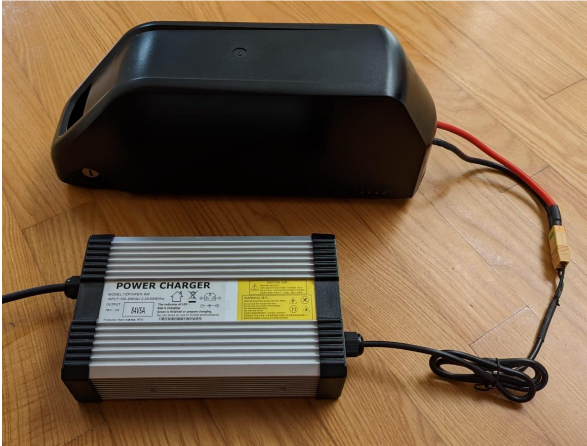
Slika 2.9 Baterija spojena na punjač
