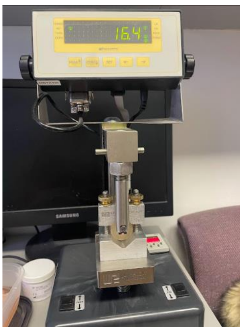
Slika 10. Trenutak odvajanja kompozita od dentina
