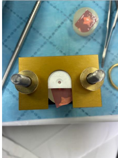
Slika 6. Uzorak s teflonskim kalupom u stezaljci
