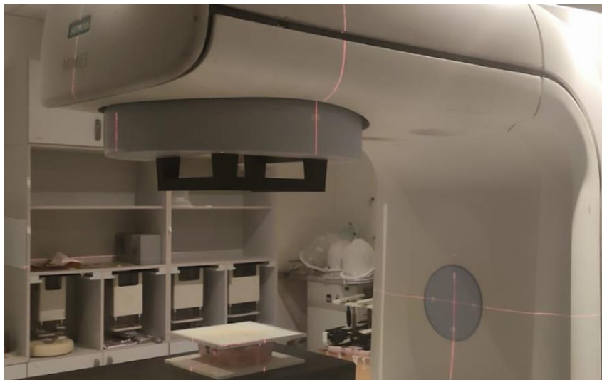
Slika 4. Uzorci u destiliranoj vodi postavljeni za zračenje na linearnom akceleratoru
