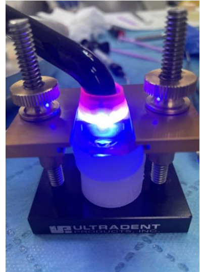
Slika 7. Polimerizacija debeloslojnog kompozita LED lampom
