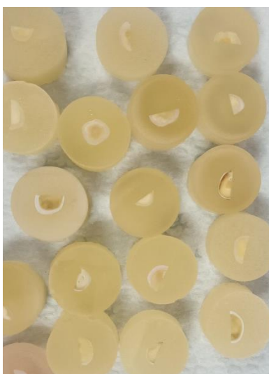
Slika 2. Dentinske pločice uložene u akrilatnu masu
