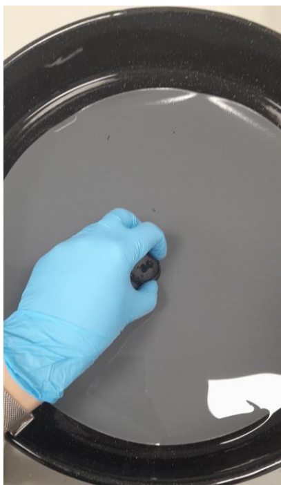
Slika 7. Poliranje dentinskog supstrata uklopljenog u akrilat.
