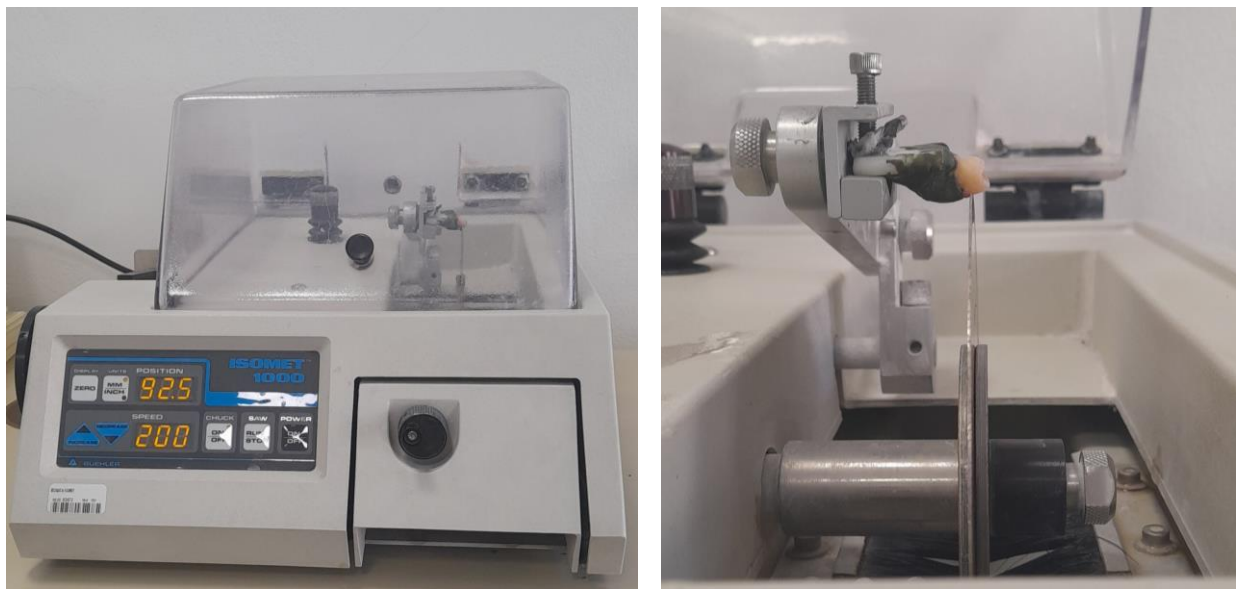
Slika 4. Rezanje zuba preciznom dijamantnom rezalicom. Oštrica je postavljena paralelno s okluzalnom plohom.
