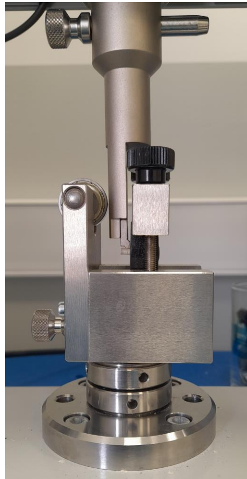
Slika 13. Položaj uzorka tijekom mjerenja čvrstoće vezivanja.
