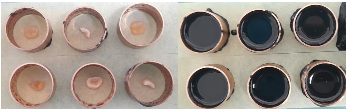
Slika 6. Uklapanje uzoraka u kemijsko-polimerizirajući akrilat.
