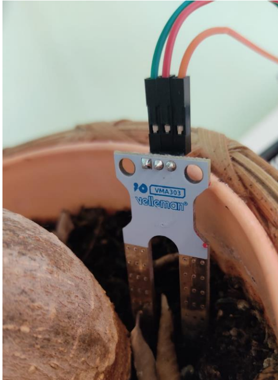
Slika 30. VMA303 senzor vlažnosti tla
