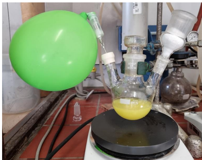
Slika 6. Provedba Wittigove reakcije u laboratoriju.
