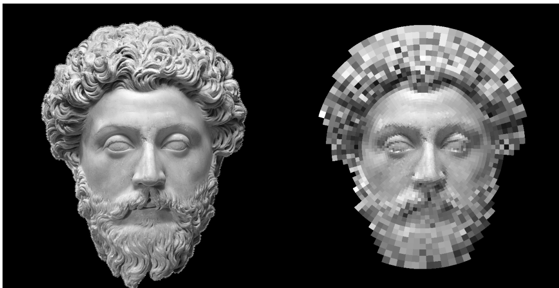
Slika 2.4: Primjer slike u kartezijskom sustavu (lijevo) i slike u log-polarnom sustavu (desno). Desna slika je preslikana nazad u kartezijski sustav radi lakše interpretacije.
