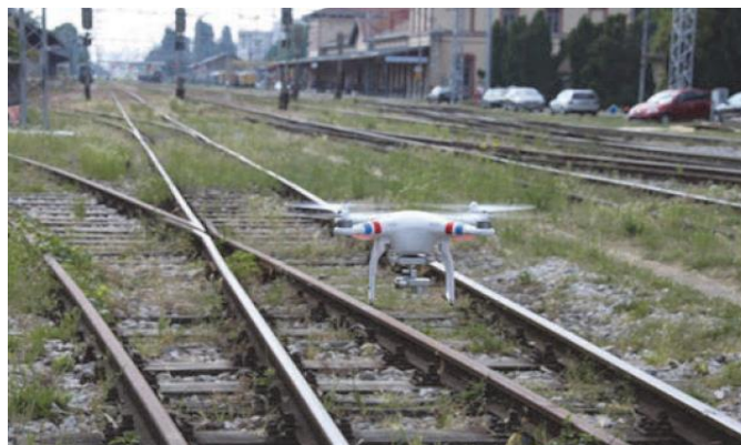
Slika 9. Snimanje kolosijeka bespilotnom letjelicom (UAV) [11]
