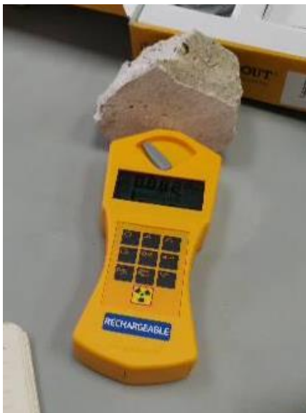
Slika 6-1. Mjerenje prirodne radioaktivnosti na uzorku Geiger-Müllerovim brojačem
