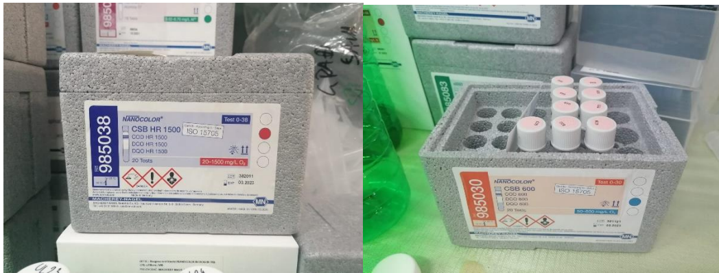
Slika 17 Reagensi NANOCOLOR COD CSB HR 1500 (20 - 1500 mg/l O 2 ) i CSB 600 (50 - 600mg/l O 2 ) za određivanje KPK
