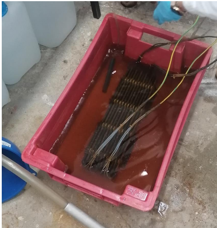
Slika 6 Postavljeni set elektroda (željezna) u reaktorsku posudu sa zauljenom otpadnom vodom
