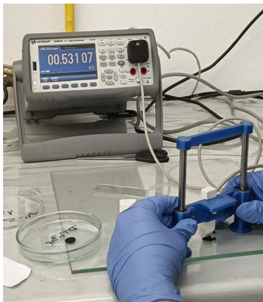
Slika 44. Provedba metode sonde s 4 točke
